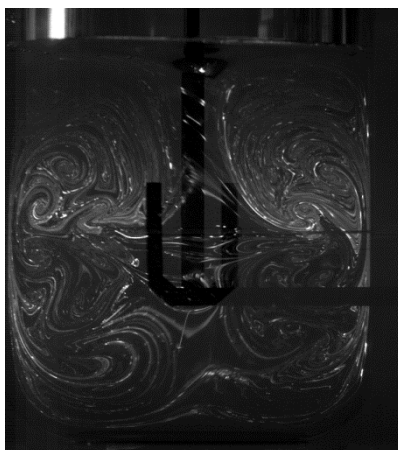
Figure I.1 : Visualisation du mélange par la méthode LIF pour une ancre avec un nombre de Reynolds d'agitation Re = 98 et un fluide de viscosité \eta = 0,2 \text{ Pa.s} (Schmidt, 2014).
