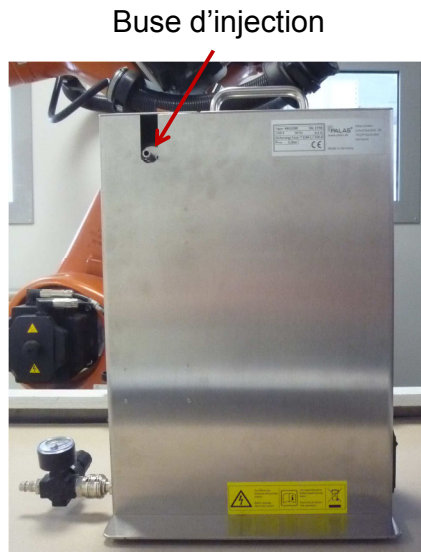
FIGURE 3.4 – Photographie du générateur Palas RBG 1000 utilisé
