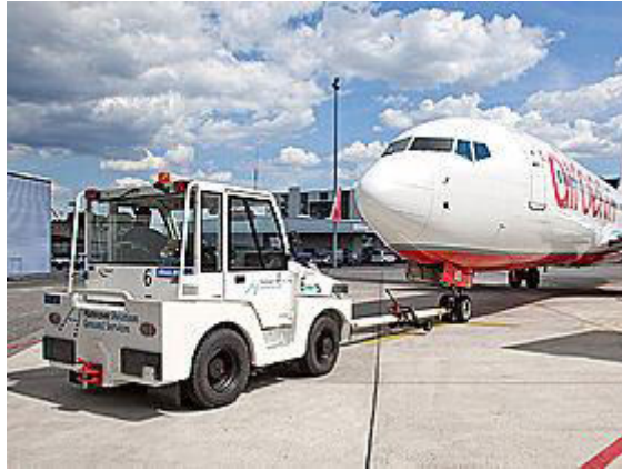
Fig.6. Exemple de tracteur pour aéronef : Le Push-back Comet 12 [MULAG]
