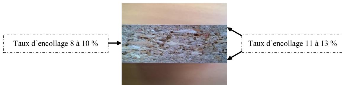
Figure 4 : Profil d'un panneau de particules
