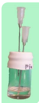
Figure II.3 Flacon d'huile essentielle utilisé pour la génération de vapeurs d'HE par bullage d'air synthétique
