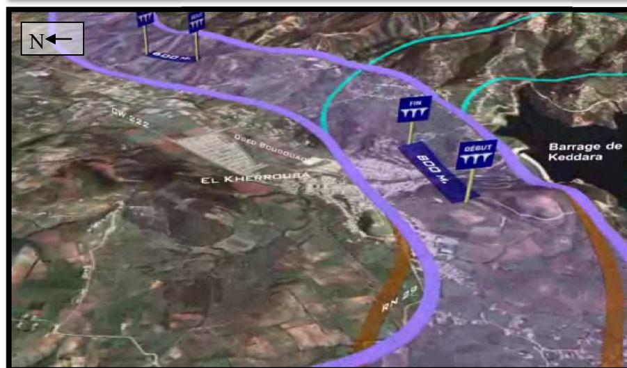
Un ouvrage d'art de 800m sera réalisé pour la traversée de oued Boudouaou, affluent vers le barrage de Keddara.
