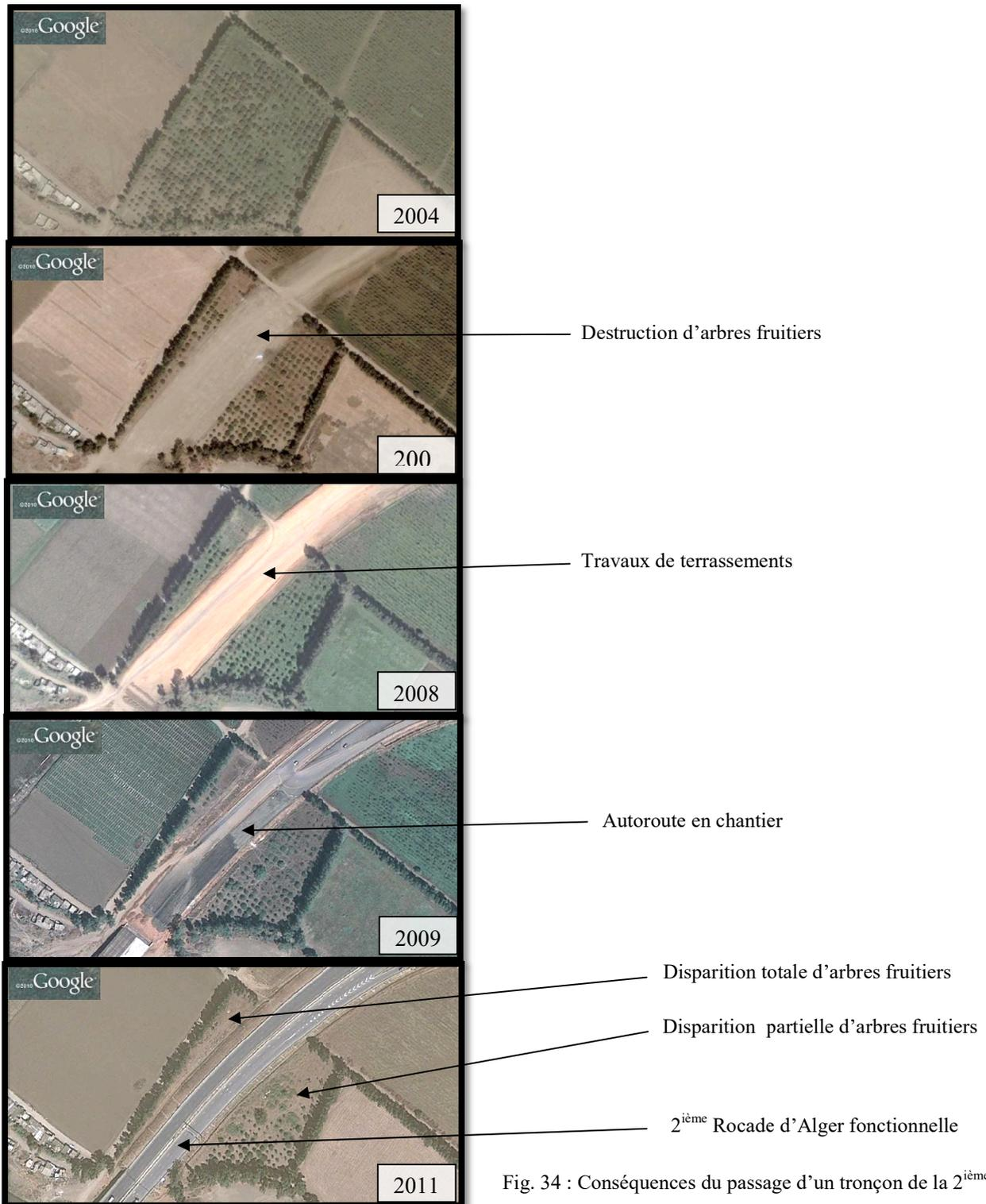
Fig. 34 : Conséquences du passage d'un tronçon de la 2<sup>ème</sup> Rocate d'Alger sur une parcelle d'arbres fruitiers dans la Mitidja (H. Bouzar, mars 2012).
