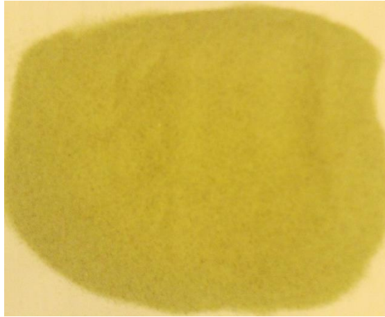
Figure 102 : Olivine blanche utilisée comme caloporteur dans les essais en gazéification
