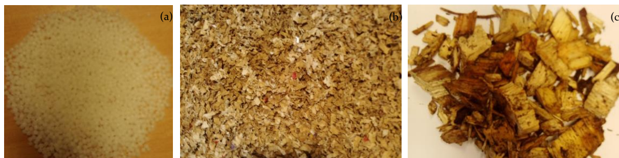
Photo 10 : granulés de PEhD (a), broyats de carton (b), plaquettes de bois (c)
