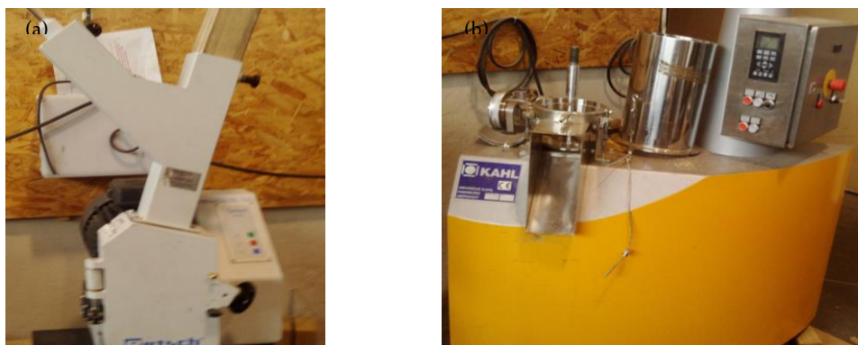
Photo 8 : broyeur (a) et presse à granulés (b)
