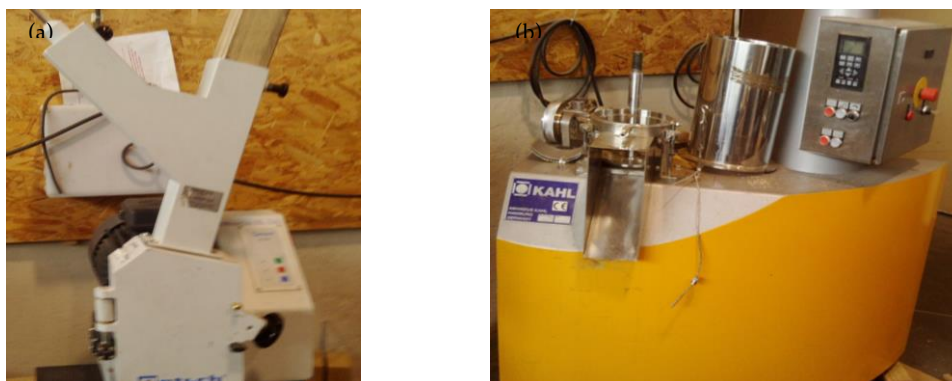
Photo 8 : broyeur (a) et presse à granulés (b)
