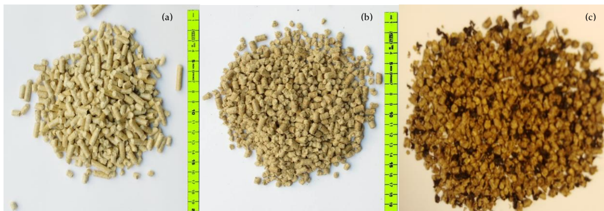
Photo 9 : granulés de fabrication industrielle (a), granulés de taille adaptée au réacteur (b) et granulés DM (c)
