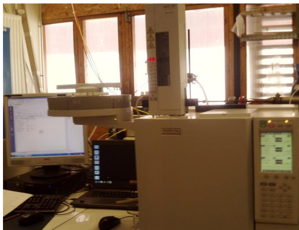
Photo 5 : système GC-FID GC-2010 Plus SHIMADZU
