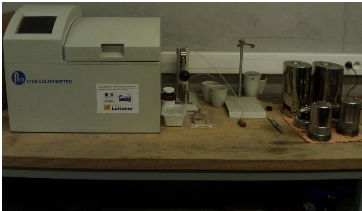
Photo 1 : Ensemble du système de détermination du PCI par bombe calorimétrique
