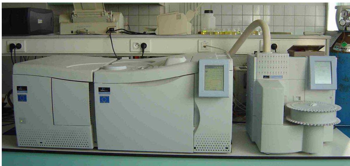
Photo 6 : Vue d'ensemble du thermodésorbeur (TurboMatrix ATD ; PERKIN ELMER) et du système d'analyse chromatographique GC - MS (Clarus 500 ; PERKIN ELMER)
