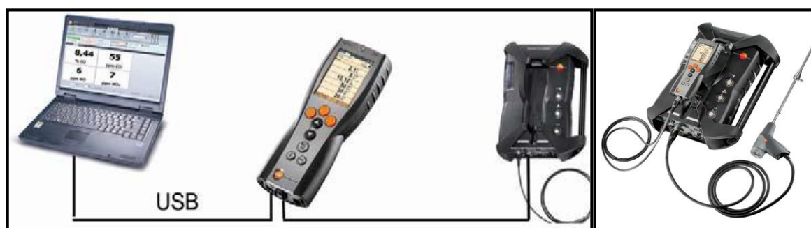
Figure 22 : Acquisition des données de l'analyseur via PC
