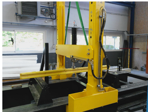
Figure 105. Flexion de la poutre en bois
