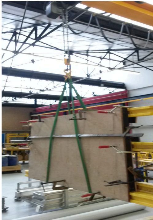
Figure 101 : Géométrie des murs en maçonnerie testés dans l'essai de flexion et illustration de la manutention du mur.
