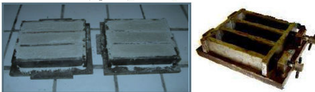
Figure 96 : Eprouvette(4*4*16) de mortier fabriqués pour tester les caractéristiques de chaque formule de mortier fabriquée
