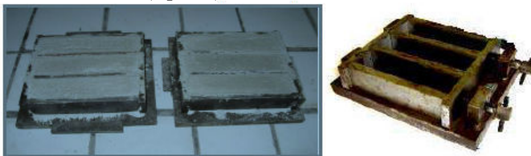
Figure 96 : Eprouvette(4*4*16) de mortier fabriqués pour tester les caractéristiques de chaque formule de mortier fabriquée
