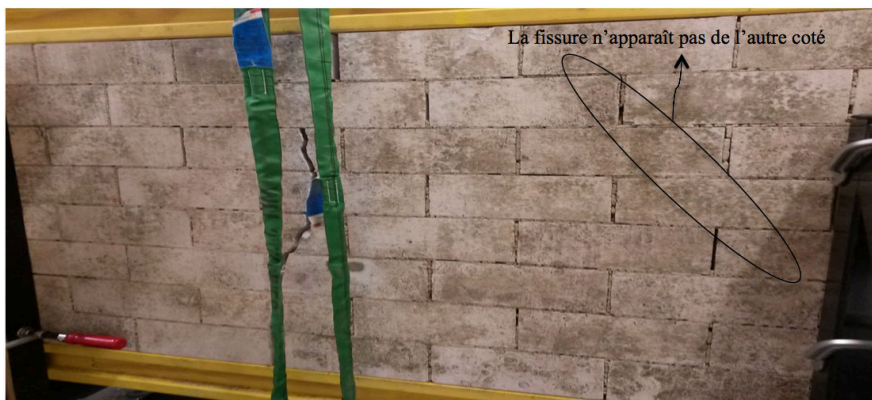
Figure 107 : Fissuration du mur F2: une fissure apparaît d'une seule part sans être visible de l'autre part du mur
