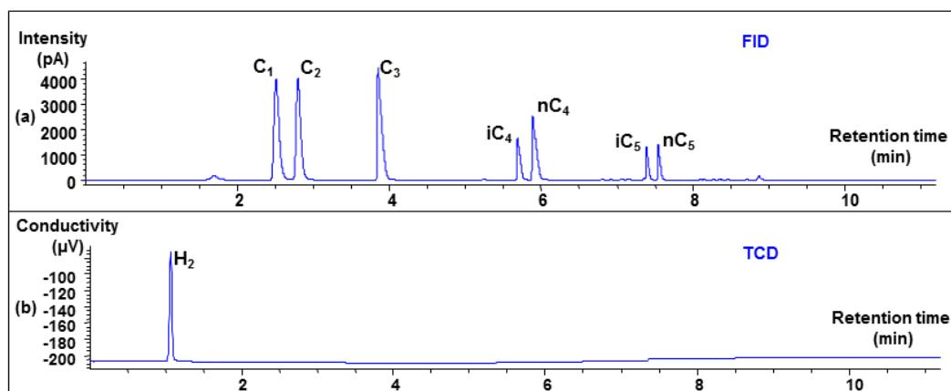
Chromatographies du gaz de calibration: détecteurs FID (a) et TCD (b)
