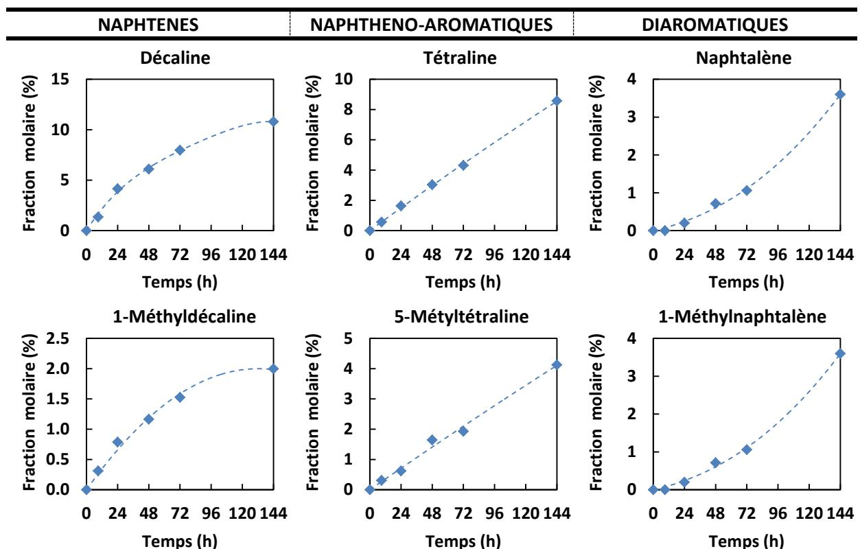
Figure 4.5 Evolution du profil des produits C<sub>6+</sub> à 400°C 100 bar (tendances en pointillés)
