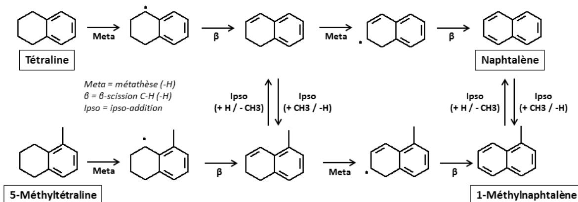
Figure 4.9 Voies de formation du napthalène et du 1-méthylnapthalène
