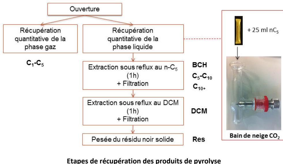
La phase gaz est directement récupérée via une ligne sous vide. Cette dernière est ensuite injectée dans un volume calibré pour déterminer la quantité totale de gaz (à l'aide de la pression) et est finalement injectée dans le système analytique ( $\mu$ GC-FID et GC-TCD) pour quantifier les hydrocarbures C<sub>1</sub>-C<sub>5</sub>.
