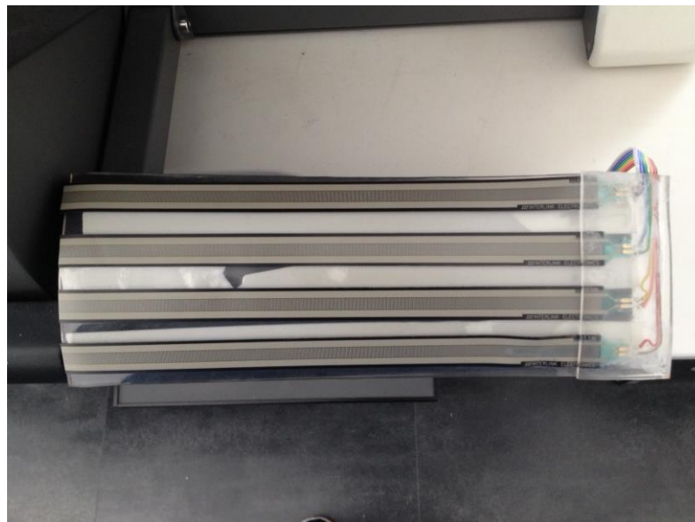
Figure 2-13 capteurs protégés et installés sur l'appui bras droit de dVT
