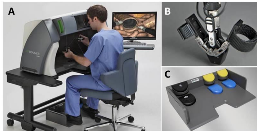
Fig. 1-3 Le simulateur robotique dV-Trainer® : la vue d'ensemble (A), la manette (B) et le pédalier (C)
