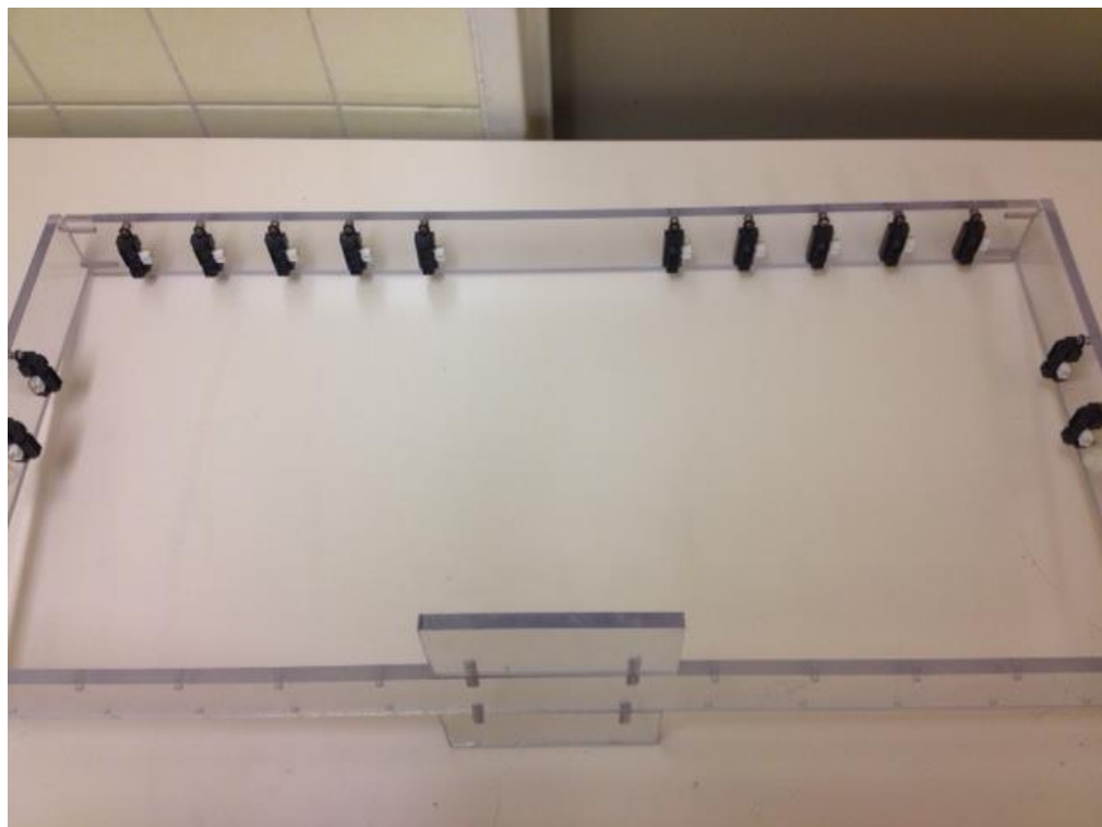
Figure 2-5 capteur infrarouge installé devant la console
