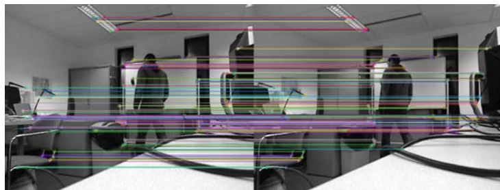
FIGURE 6.3 – Mise en correspondance des pixels entre deux images. Cette correspondance est représentée par les lignes joignant les pixels.
