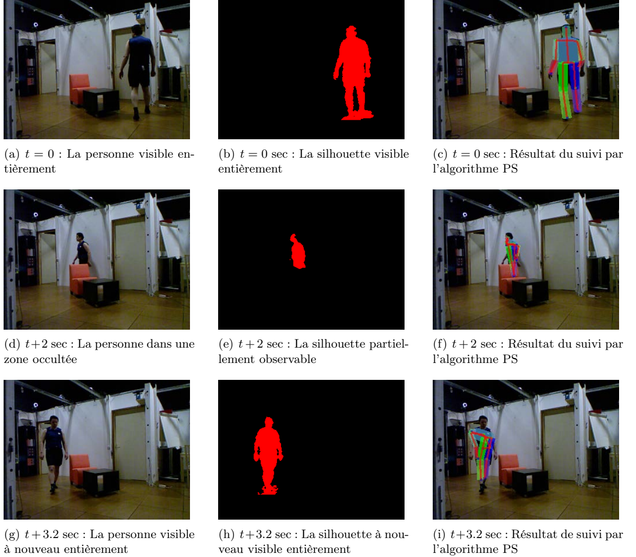
FIGURE 4.6 – Exemple montrant l'incapacité des algorithmes de filtrage particulaire à suivre le mouvement d'une personne dont la silhouette est partiellement observable.
