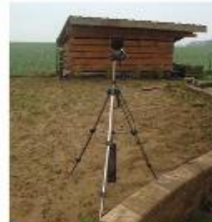
Photo d'un micro pour l'enregistrement du bruit ambiant à l'extérieur d'une habitation
