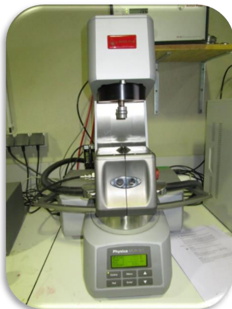
Figure 2.11 : fermeture du dispositif immédiatement après application de la résine
