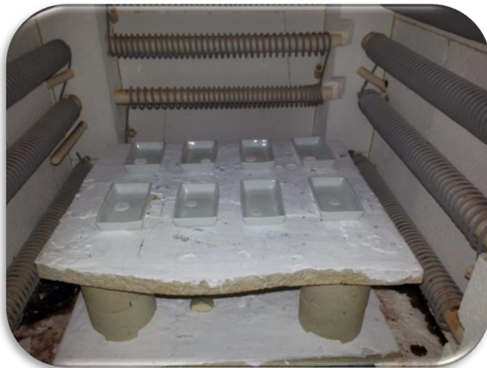
Figure 2.8 : échantillons après calcination
