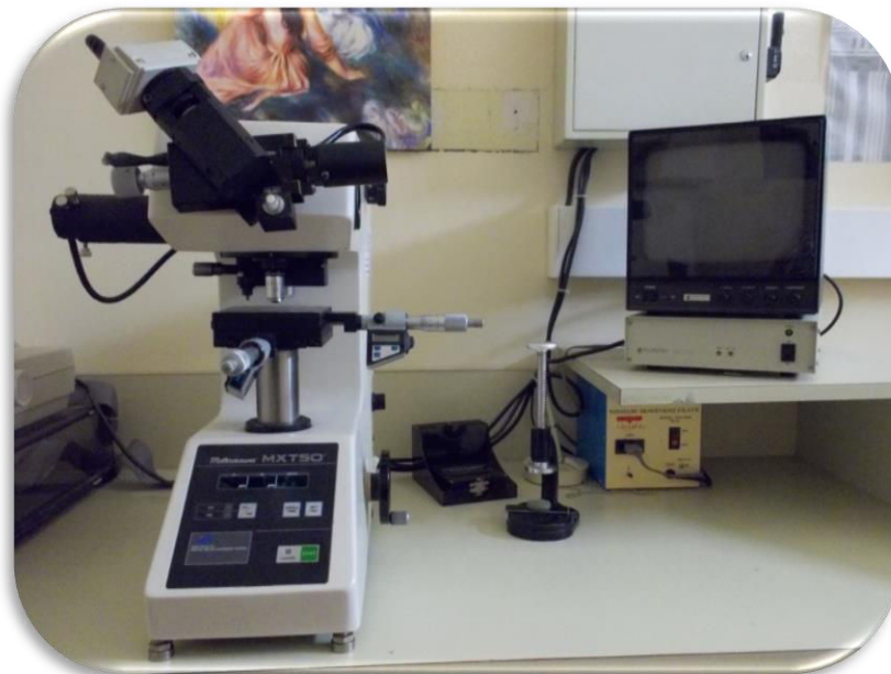
Figure 2.14 : dispositif de mesure de dureté Vickers
