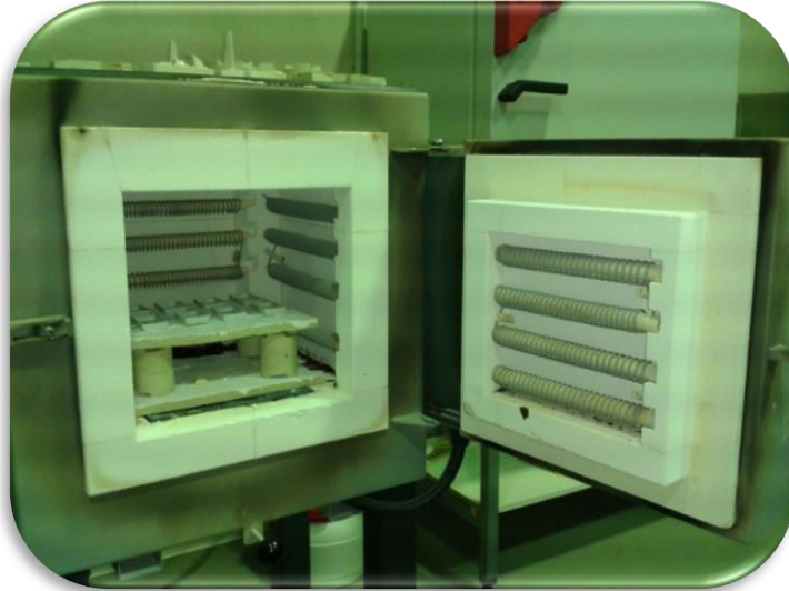
Figure 2.7 : mise au four des échantillons préalablement pesés
