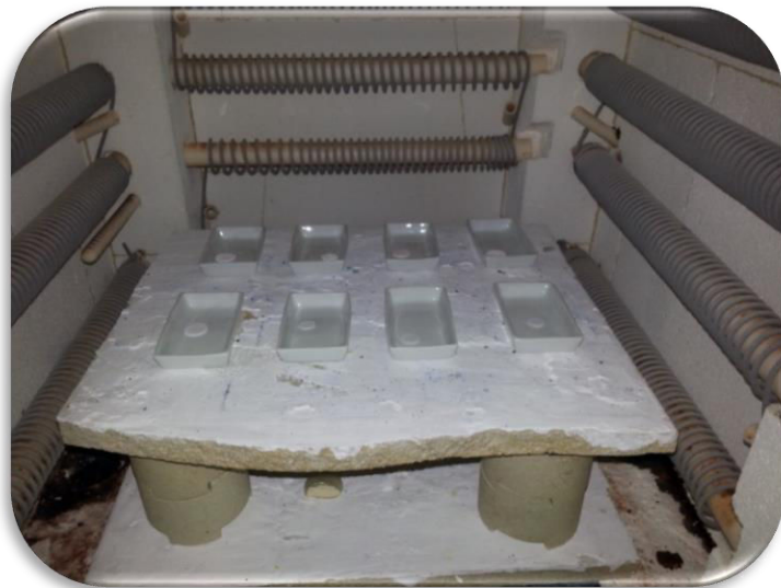
Figure 2.8 : échantillons après calcination
