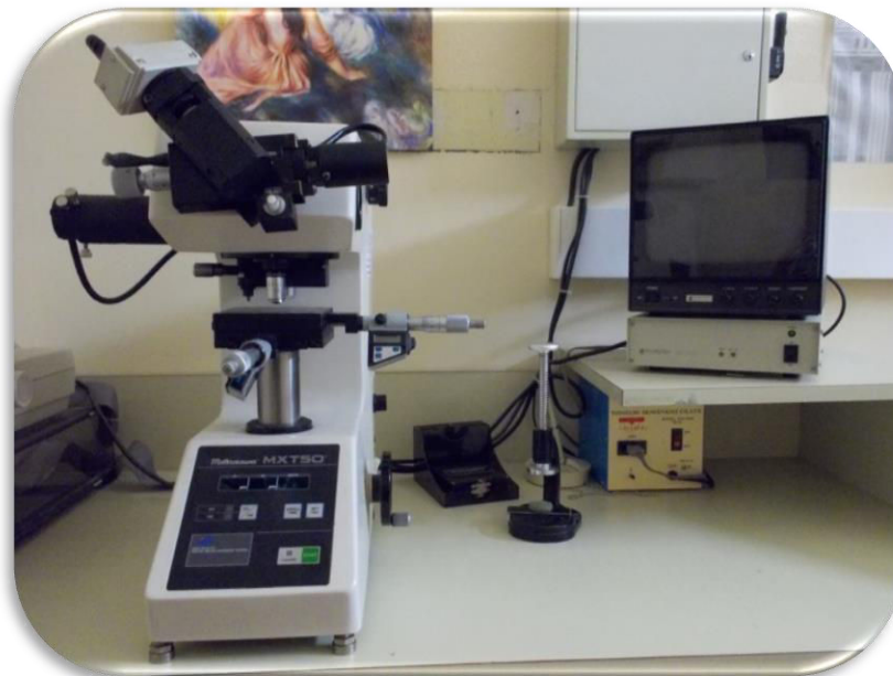
Figure 2.14 : dispositif de mesure de dureté Vickers
