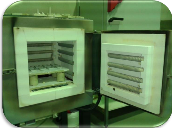
Figure 2.7 : mise au four des échantillons préalablement pesés
