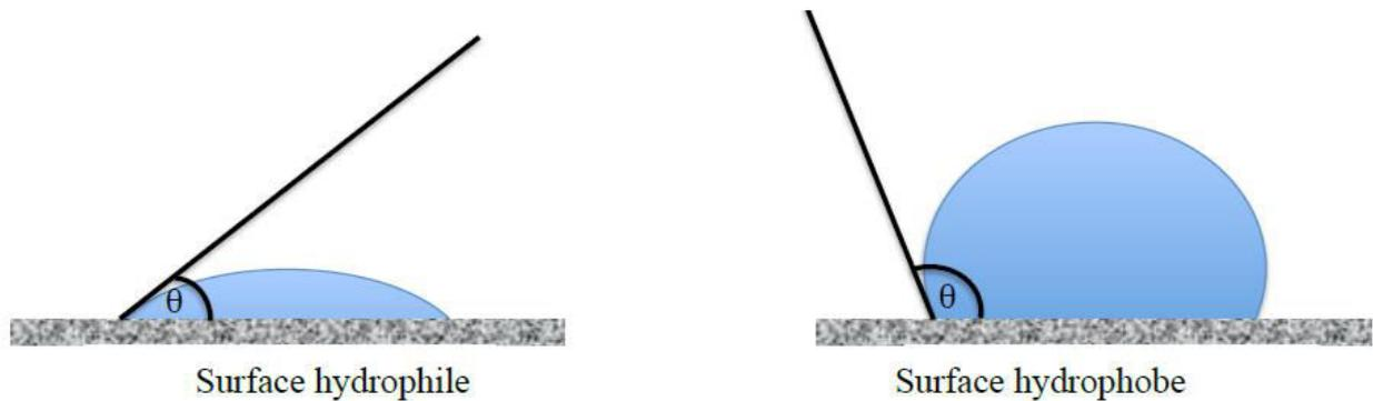
**Figure 30: Illustration de l'angle de contact d'une goutte d'eau avec une surface hydrophile et une surface hydrophobe.**
