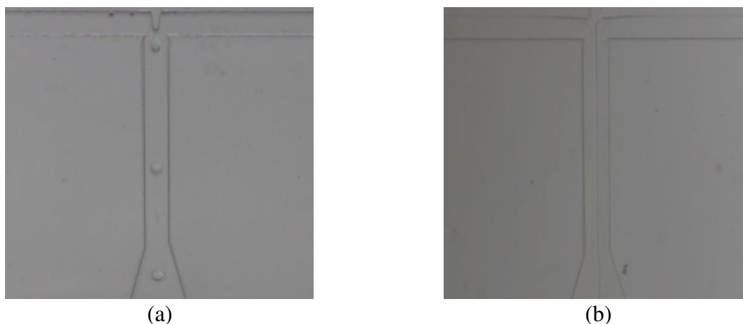
Figure 122: Formation d'émulsion à l'intérieur du système microfluidique en utilisant une phase continue (a) non saturée en GO (b) saturée en GO ( phase dispersée : Solvant = AcOEt, C_{PLA/phase\ dispersée} = 8\text{ g/L} , C_{GO/phase\ dispersée} = 2\text{ g/L} , Q_d = 0,3\text{ mL/h} , phase continue : C_{Dexc6} = 5\text{ g/L} , Q_c = 6\text{ mL/h} ).
