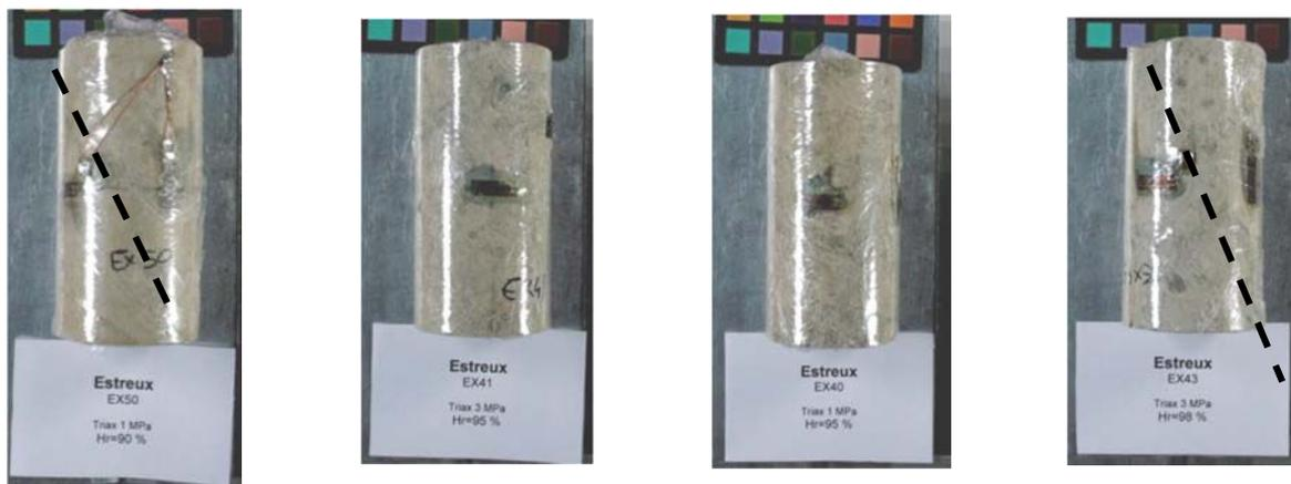
Figure III.27 : Photographies d'échantillons après essai de compression triaxiale, en fonction de l'état hydrique, et formes de rupture. Craie d'Estreux
