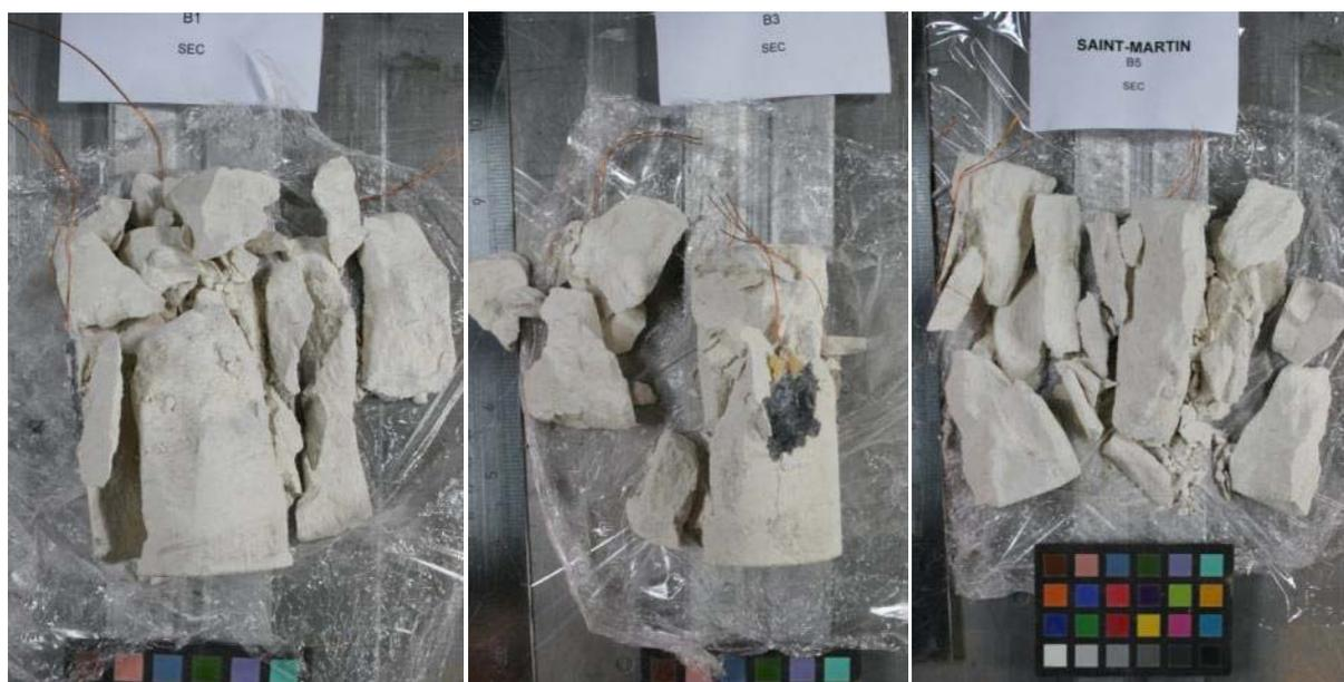
*Figure V.4 : Photographie des échantillons de fluage après essai montrant la forme des ruptures. Série en condition sèche. Craie de Saint-Martin-le-Nœud*
