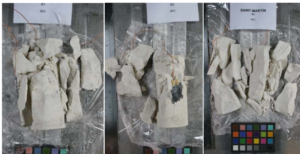
Figure V.4 : Photographie des échantillons de fluage après essai montrant la forme des ruptures. Série en condition sèche. Craie de Saint-Martin-le-Nœud
