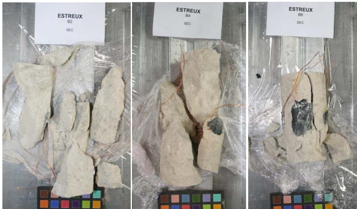
Figure V.11 : Photographies des échantillons de fluage après essai montrant les formes de rupture. Série en condition sèche. Craie d'Estreux
