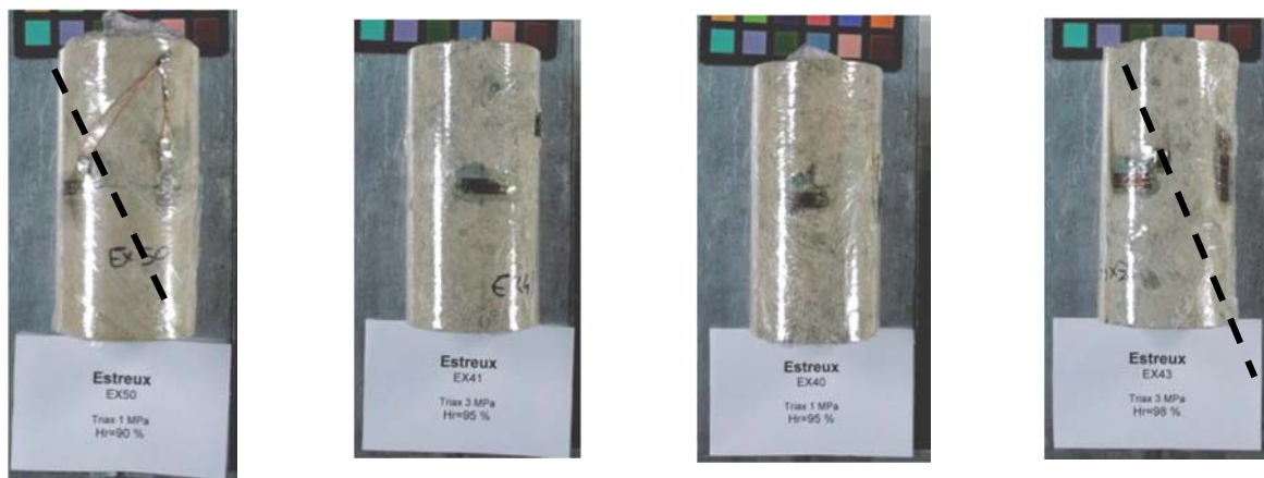
Figure III.27 : Photographies d'échantillons après essai de compression triaxiale, en fonction de l'état hydrique, et formes de rupture. Craie d'Estreux
