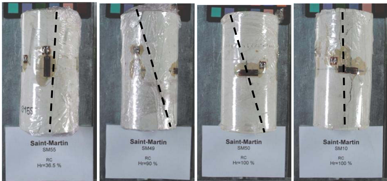
Figure III.16 : Photographies d'échantillons après essai de compression uniaxiale en fonction de l'état hydrique, et formes de rupture. Echantillons placés initialement à des hygrométries respectives de 36 %, 90 % et 100 %.
