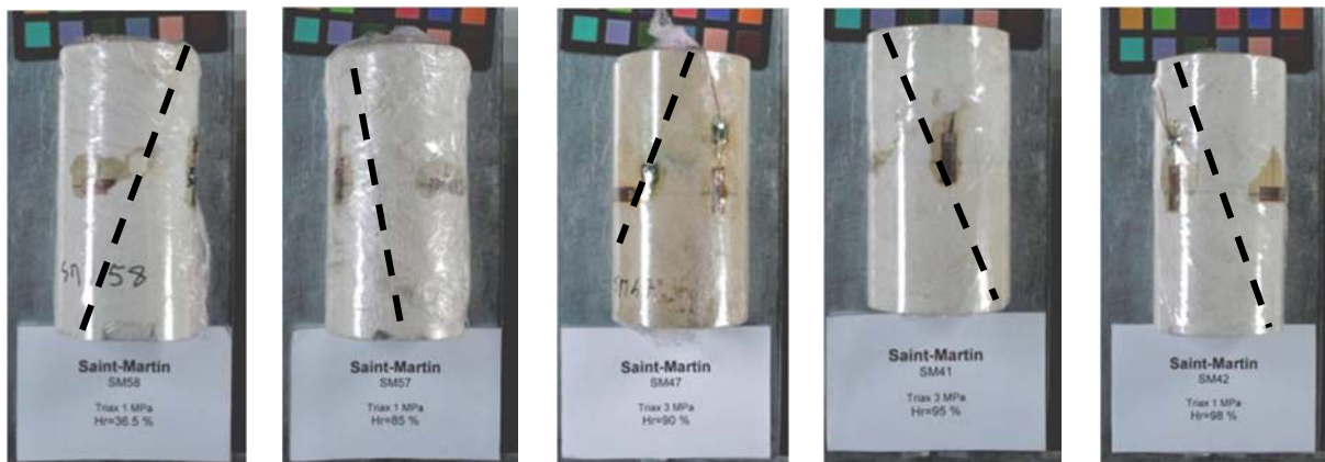
Figure III.24 : Photographies d'échantillons après essai de compression triaxiale, en fonction de l'état hydrique, et formes de rupture. Craie de Saint-Martin-le-Noeud
