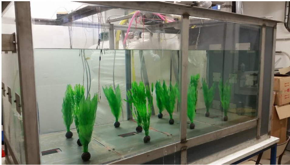
Figure 5-13: Disposition des plantes aquatiques artificielles mimant des herbiers d'élodées
