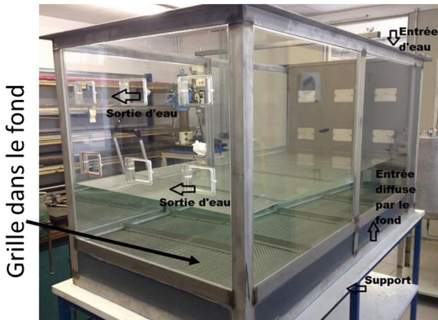
Figure 2-5: Photographie de la structure du pilote
