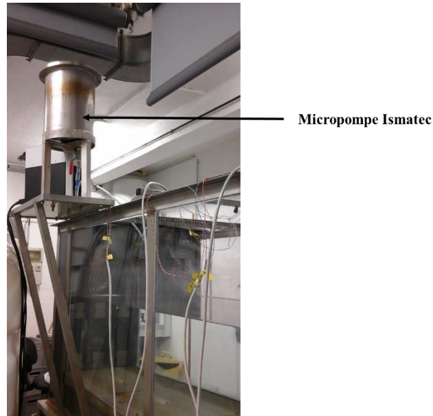
Figure 2-29: Micropompe Ismatec (Ismatec, France) utilisée pour l'injection expérimentale de principe actif en continu
