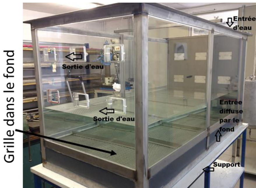
Figure 2-5: Photographie de la structure du pilote
