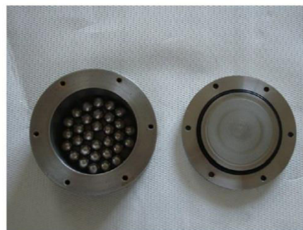
Figure II.4 : Présentation du broyeur planétaire. a) broyeur planétaire ; b) bol contenant les billes de broyage
