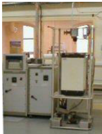
Figure II.2 : Four de traitement thermique sous vide utilisé pour les traitements thermiques
