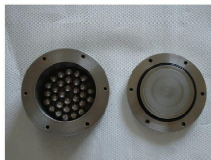
Figure II.4 : Présentation du broyeur planétaire. a) broyeur planétaire ; b) bol contenant les billes de broyage
