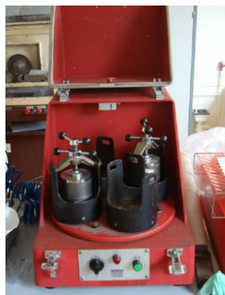
Figure II.4 : Présentation du broyeur planétaire. a) broyeur planétaire ; b) bol contenant les billes de broyage
