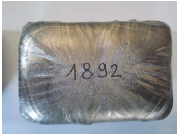
Figure II.1 : Présentation du four à arc utilisé dans l'élaboration de nos alliages. a) Four à arc ; b) Arc électrique chauffant le métal ; c) Lingotin obtenu (largeur 65mm)
