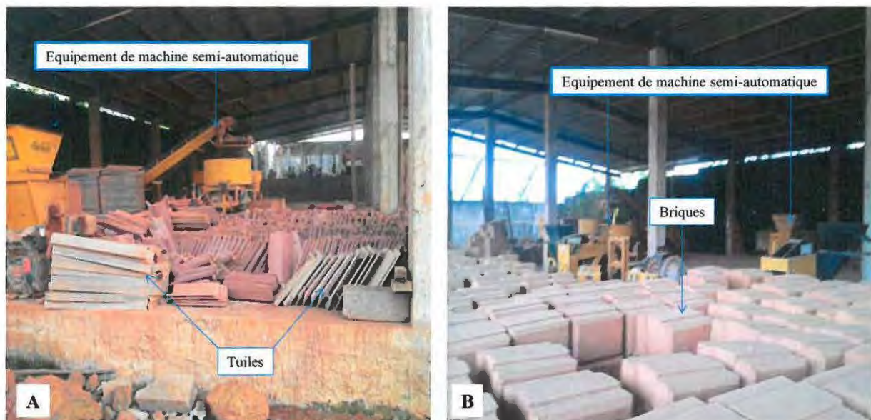
Figure IV.1.2.2 : Equipement de machine semi-automatique et production de tuiles (A) et briques (B) de l'unité de fabrication de la Société Ralph et Kevin construction d'Agondjé
