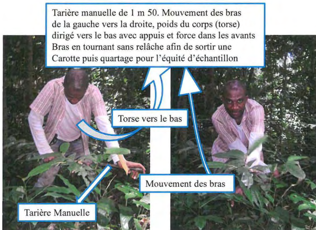
Figure III.3.1: Technique de prélèvement d'échantillon d'argiles à l'aide de la tarière manuelle
