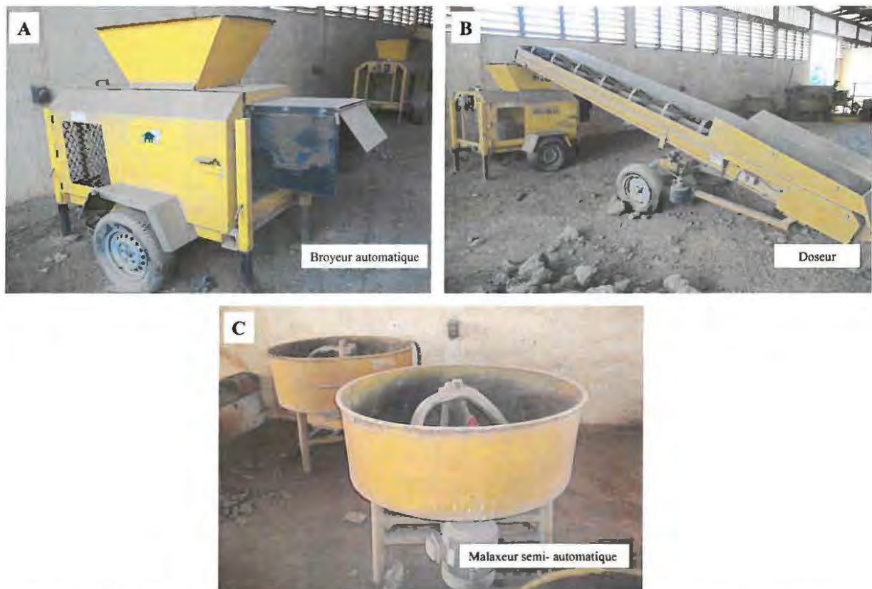
Figure IV.1.1.2 : Appareillage utilisé pour la fabrication des briques crues de l'unité de fabrication des briques de Nzeng- Ayong composée de Broyeur automatique (A), Doseur (B) et Malaxeur semi-automatique (C)
