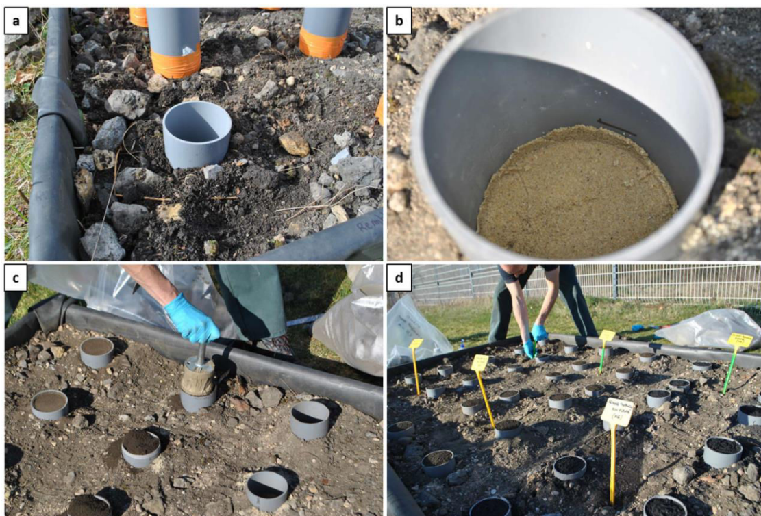
Figure VIII-9 : Photographies de la mise en place des colonnes de suivi de l'atténuation naturelle : (a) implantation des cylindres dans le sol encaissant, (b) dépôt des couches de sable filtrant, (c) tassement à la main du filtre et (d) état global au temps initial
