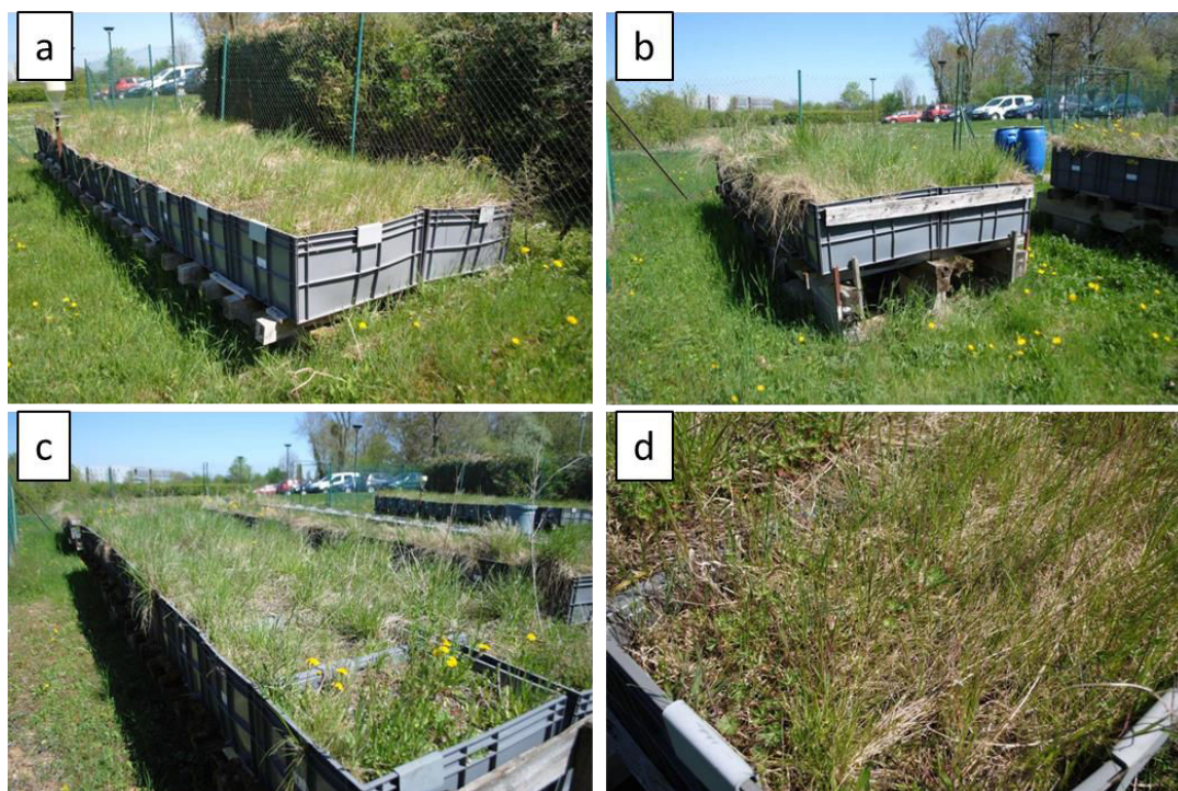
Figure XI-6 : Photographies du dispositif des bacs lysimétriques contenant les terres de cokeries d'Homécourt (a) et de Thionville (b) et les terres d'usine à gaz (c) et photographies de la surface du bac n°1 contenant la terre d'Homécourt (d)
