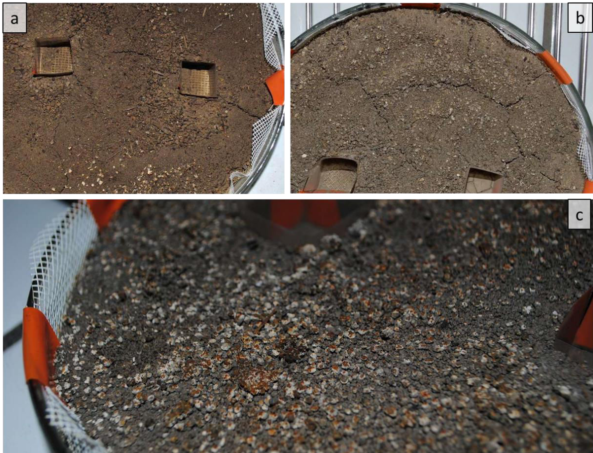
Figure VI-6 : Etat de surface des terres après vieillissement tropical (Aw - séquence tropical – Darwin) : zoom sur les fissures de surface (A) et (b) et sur la teinte rouille des particules (c)
