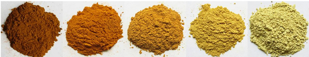
FIGURE 5 – PHOTOGRAPHIE DE PIGMENTS \text{LaFe}_{1-x}\text{Al}_x\text{O}_3 ( x=0, 0,1, 0,3, 0,5, 0,7 ) 21
