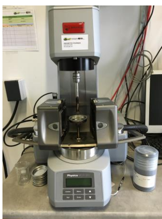
Fig. 2.43 : Viscosimètre de type RHEOPLUS MCR 301.
