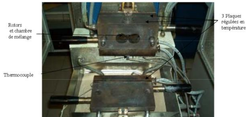
Fig. 2.37 : Mélangeur interne de type Brabender .
