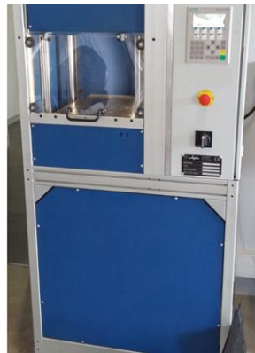
Fig. 2.42 : Presse Agila pour préparer les plaques.
