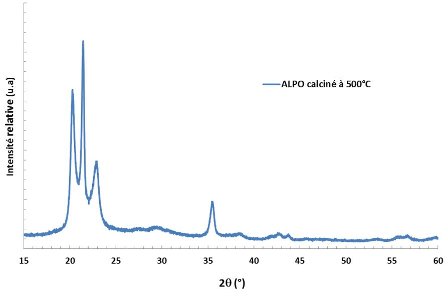
Fig. 3.27 : Diffractogrammes de rayons X d'aluminophosphate (AlPO-4) calciné à 500°C.
