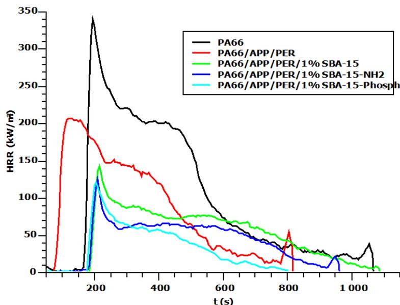
Figure 4.57: Courbes HRR des composites PA66, PA66/APP/PER et PA66/APP/PER/1%( SBA-15, SBA-15-Phosph et SBA-15-NH<sub>2</sub>) obtenues au cône calorimètre sous une irradiance de 35 kW/m<sup>2</sup>.
