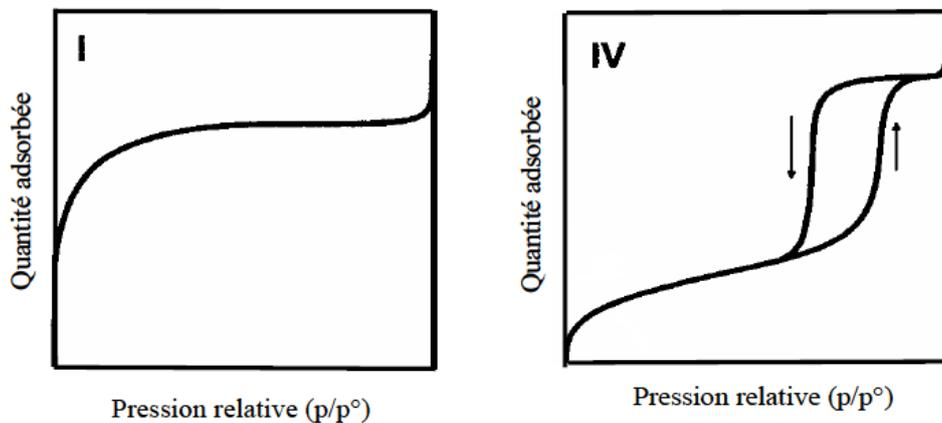
Fig. 2.32 : Isothermes d'adsorption/désorption de type I et IV.
