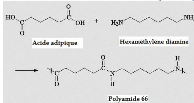
Fig. 1.21 : La polycondensation complète de Polyamide 66.
