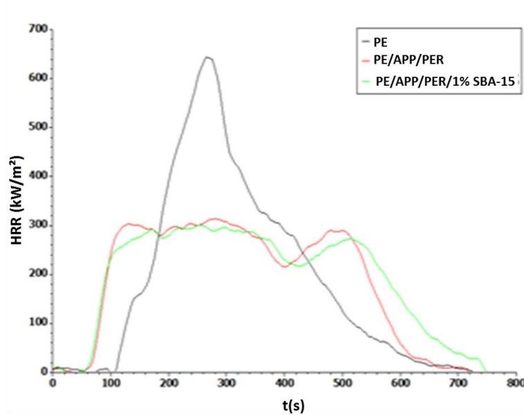
Figure 4.14: Courbes HRR du PE seul et des composites PE/APP/PER et PE/APP/PER/1%SBA-15.
