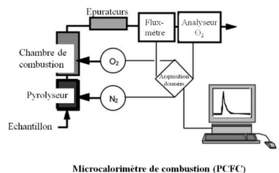
Fig. 2.47 : Schéma de principe du PCFC.
