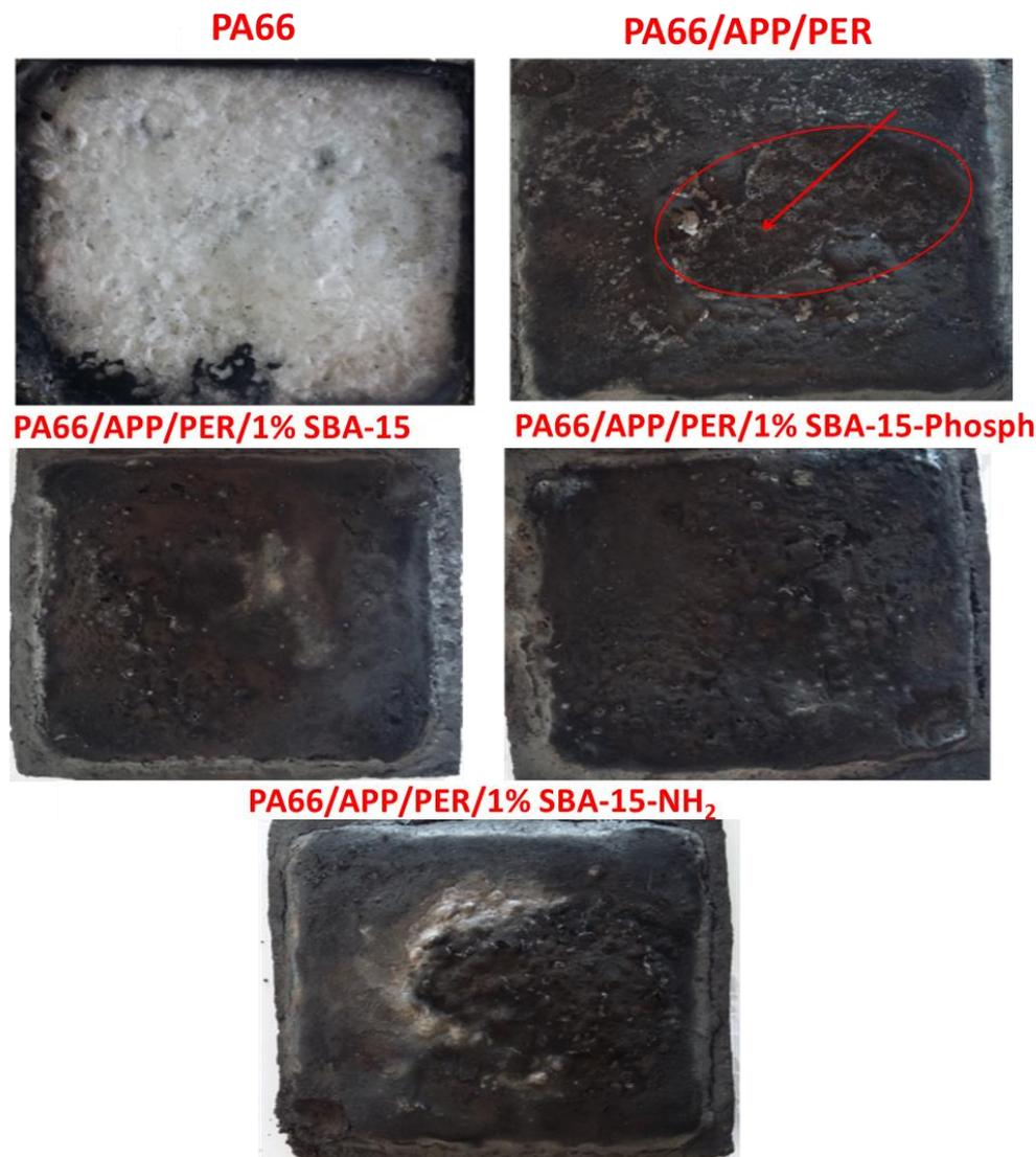
Figure 4.59 : Résidus obtenus après un test au cône calorimètre.
