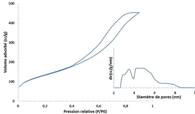
Fig. 3.7 : Isotherme d'adsorption/désorption de la silice commerciale et distribution en taille de pores.
