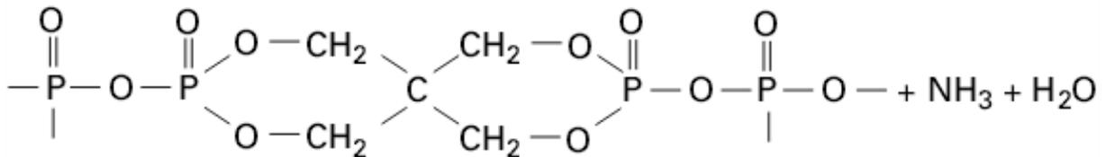
Fig. 1.10 : Structure du diphosphate de pentaérythritol.
