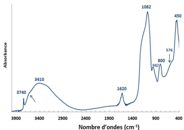
Fig. 3.9 : Spectre DRIFTS du SBA-15 parent.
