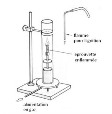
Fig. 2.44 : Schématisation du test de détermination d'LOI.
