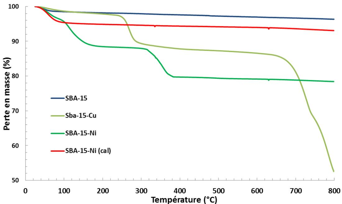
Fig. 3.26 : Comparaison des courbes ATG des différents SBA-15-imprégnés.
