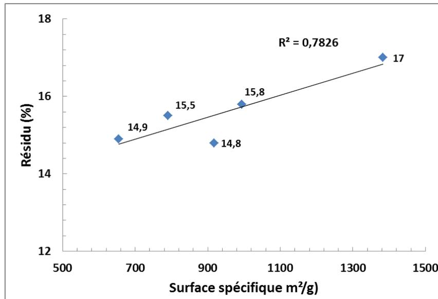
Fig. 4.23 : Relation entre la surface spécifique et le taux du résidu observé en ATG.
