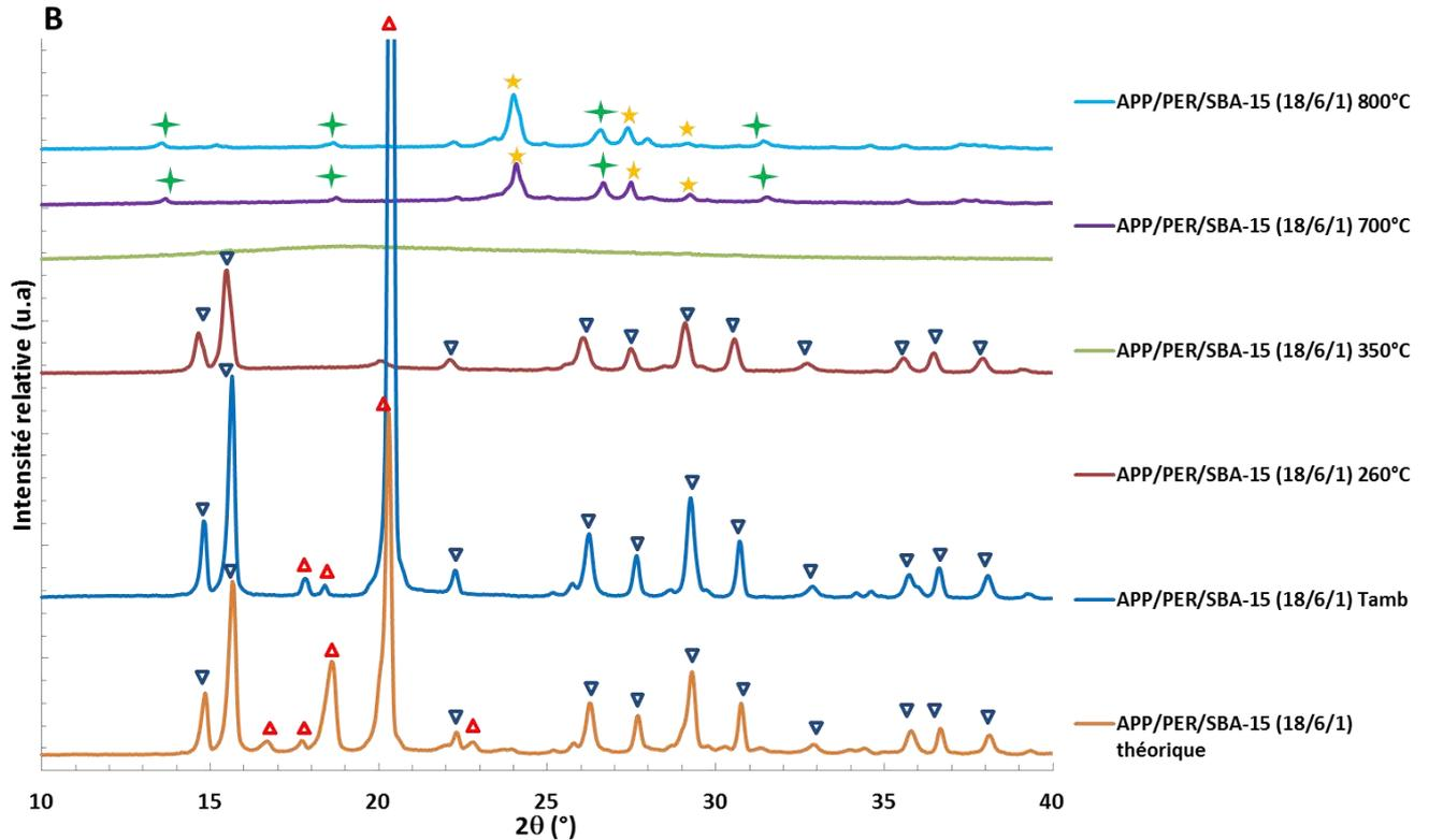
Fig. 3.44 : Diffractogrammes des mélanges APP/PER (3/1) et APP/PER-SBA-15 (18/6/1) après traitement (3min) sous air à différentes températures.
