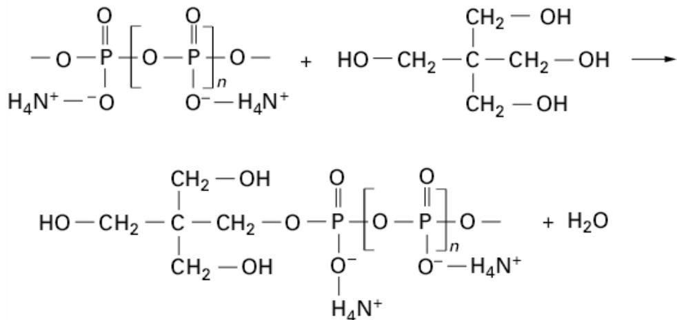
Fig. 1.8 : Le mécanisme de réaction entre APP/PER.
