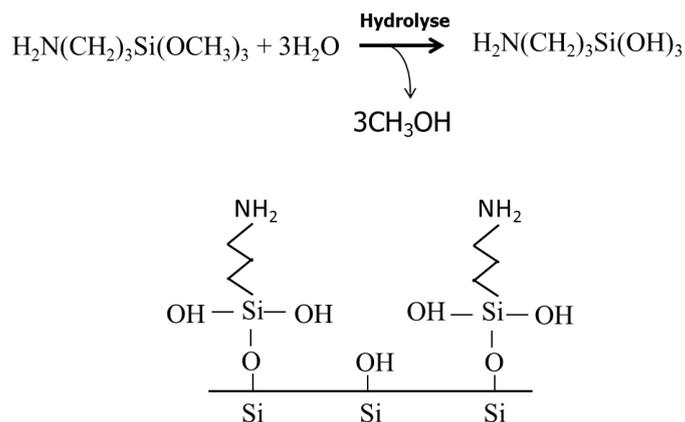
Fig. 3.19 : Interaction entre le SBA-15 et l'APTMS.
