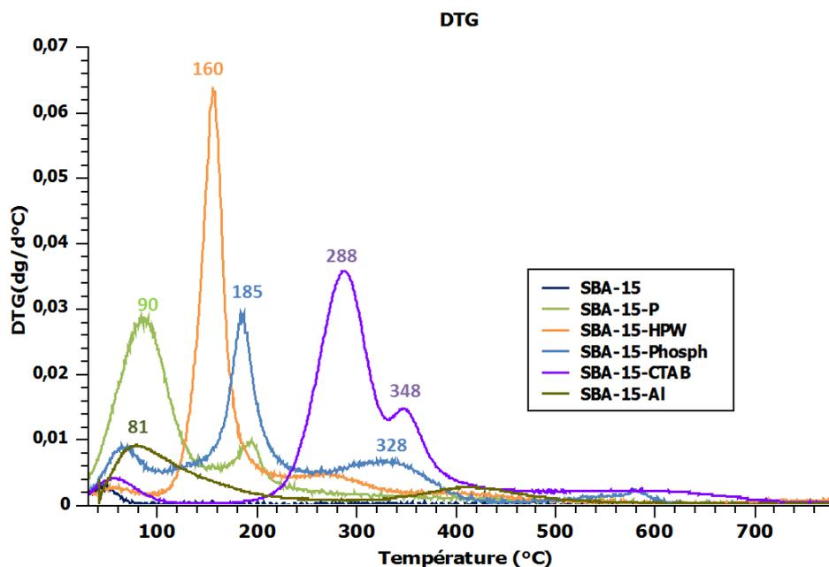
Fig. 3.20 : Courbes ATG et DTG des SBA-15 fonctionnalisés en post-synthèse ou co-condensation.
