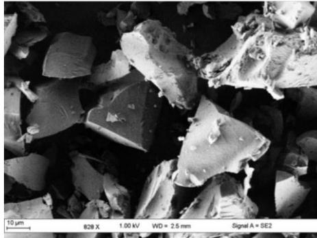
Fig. 2.27 : Cliché MEB de la silice commerciale.
