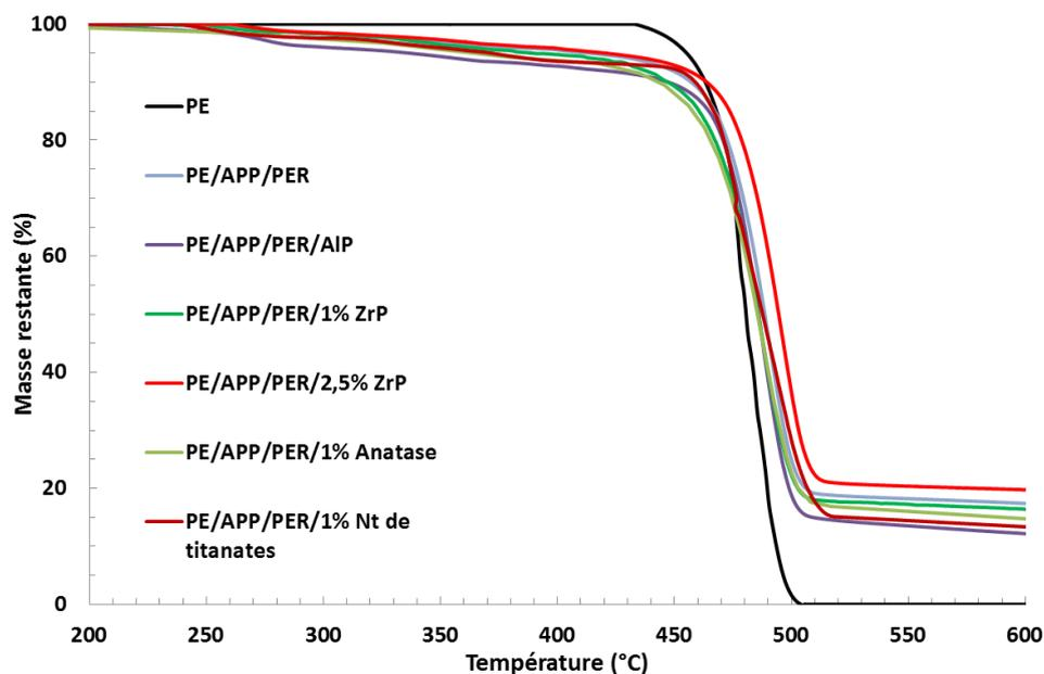
Fig. 4.36 : Courbes ATG du PE seul, PE/APP/PER/SBA-15 et des systèmes (A) PE/APP/PER/ $\alpha$ -ZrP, (B) PE/APP/PER/AIP et (c) PE/APP/PER/Anatase et PE/APP/PER/nt de titanates avec une vitesse de chauffage de 10°C/min sous azote.
