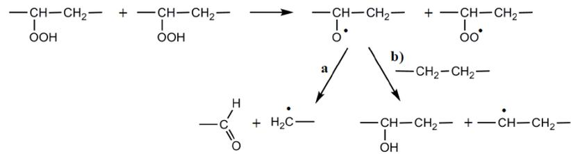
Concernant l'étape de propagation, de nombreux auteurs [52-53] ont suggéré que cette étape se déroulerait en deux temps : d'une part la réaction d'addition de l'oxygène sur un radical alkyl (1), et d'autre part, l'arrachement d'un hydrogène labile par un radical peroxyyl entraînant la formation d'un nouveau radical alkyl et d'un hydroperoxyde (2).
