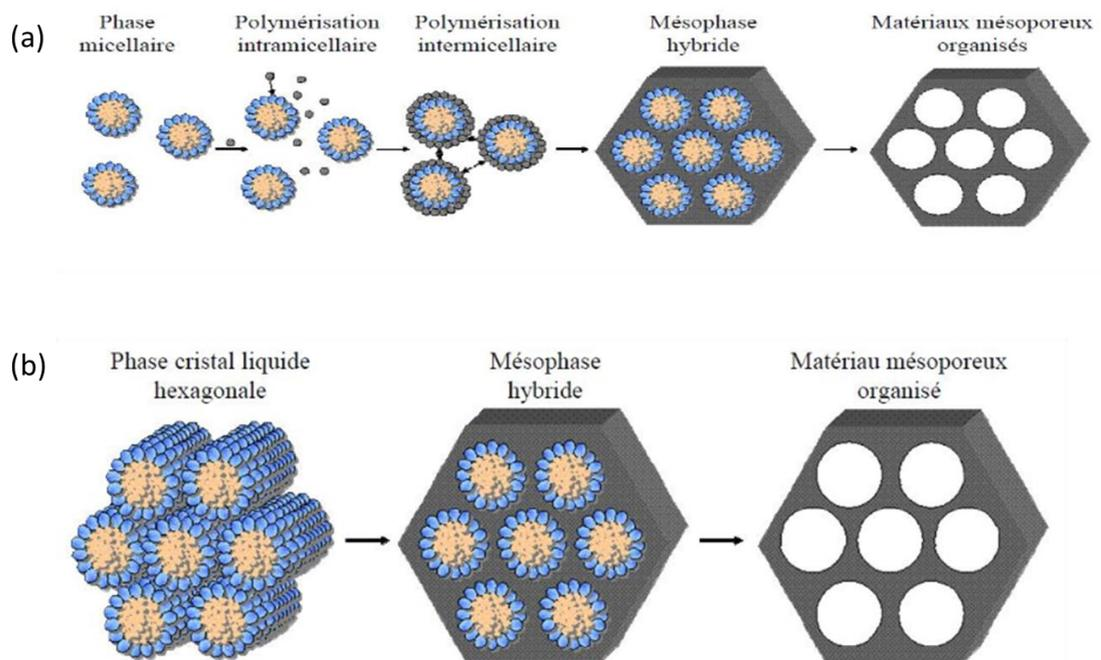
Fig. 2.8 : (a) mécanisme d'auto-assemblage coopératif (CTM); (b) mécanisme transcriptif (LCT).
