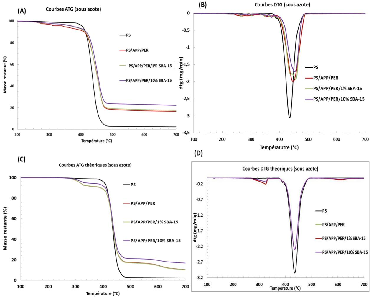
Fig. 4.43 : Courbes ATG expérimentales et théoriques et DTG du PS seul et des composites PS/APP/PER et PE/APP/PER/SBA-15 sous azote (A-D)) (vitesse de chauffage de 10°C/min).
