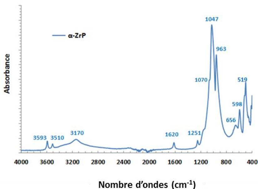
Fig. 3.31 : Spectre ATR du  $\alpha$ -ZrP synthétisé.
