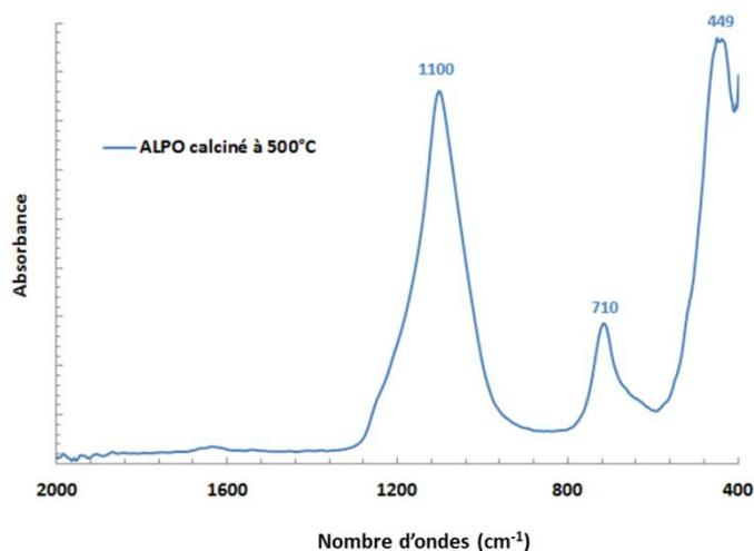
Fig. 3.29 : Spectre ATR d'aluminophosphate calciné à 500°C.
