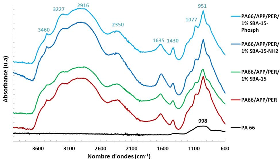
Fig. 4.63 : Spectres infrarouges des résidus au cône calorimètre.
