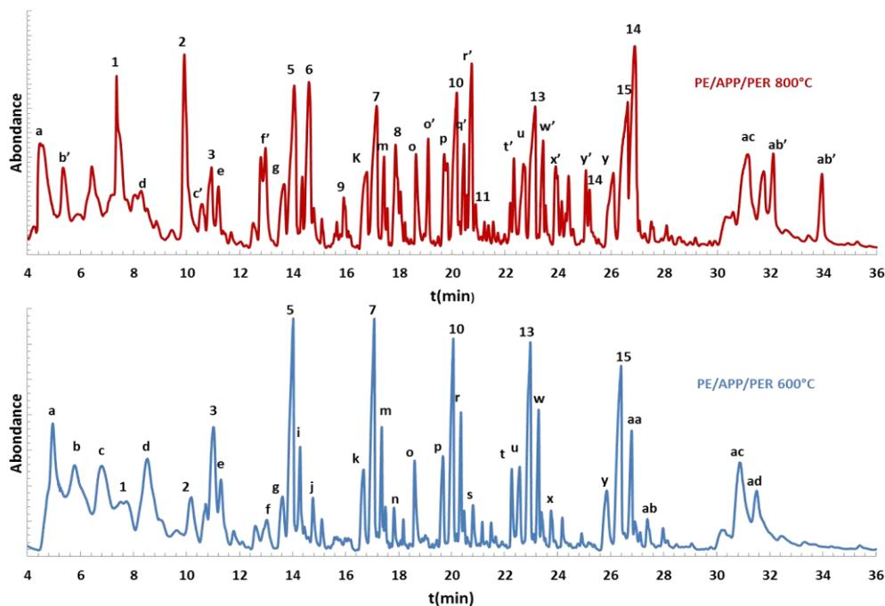
Fig. 4.7 : Chromatogrammes obtenus lors de la pyrolyse du mélange PE/APP/PER à 600 et 800°C (pendant 60s).
