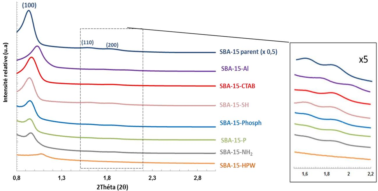
Fig. 3.11 : Diffractogrammes de rayons X aux petits angles des échantillons de SBA-15 modifiés chimiquement.
