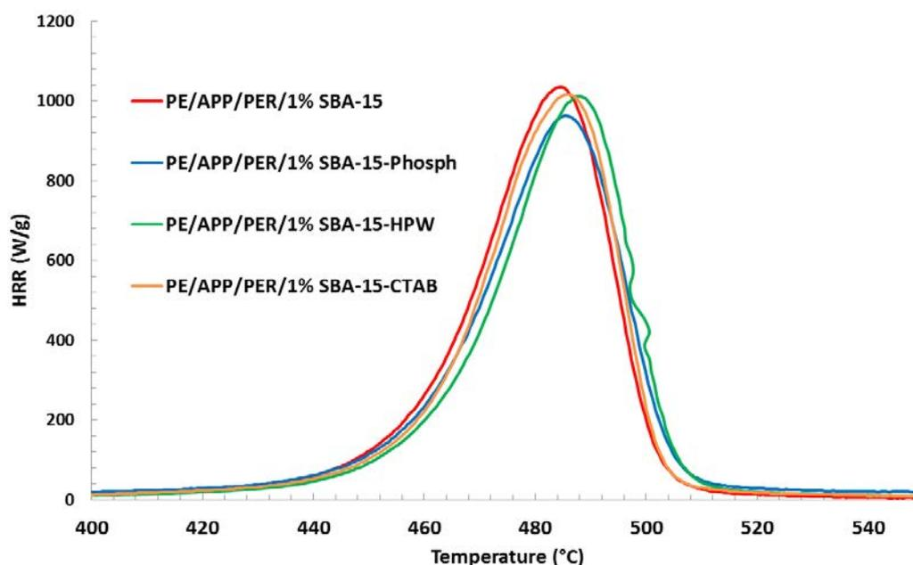
Fig. 4.32 : HRR en fonctions de la température.
