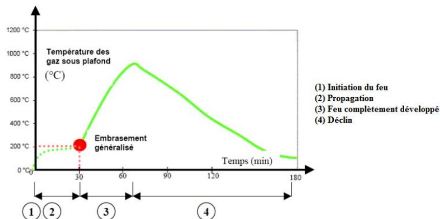
Fig. 1.3 : Les phases du déroulement d'un incendie [5].
