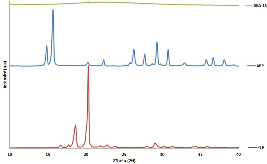
Fig. 3.43 : Diffractogrammes de l'APP, PER et du SBA-15.
