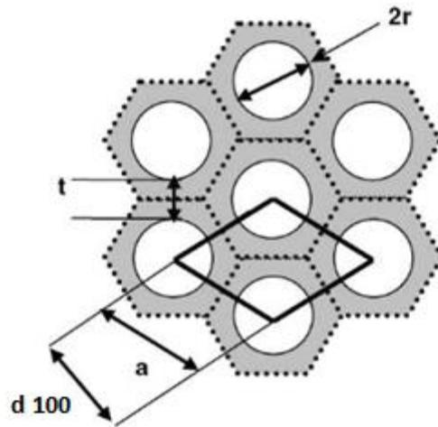
Fig. 2.30 : Schématisation de l'arrangement de pore [37].
