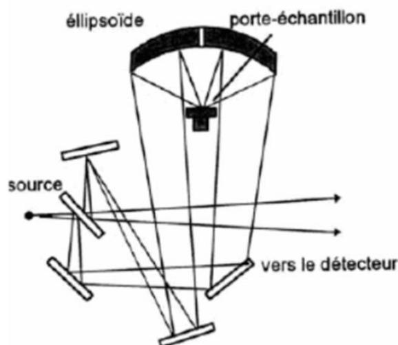
Fig. 2.35 : Schéma du principe de réflexion diffuse.
