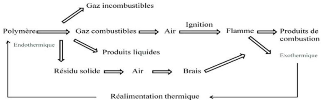
Fig. 1.2 : Pyrolyse et combustion d'un polymère.
