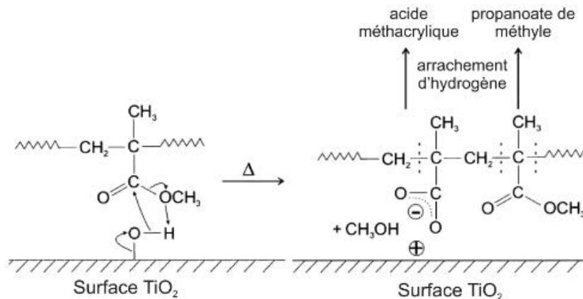
Fig. 1.28 : Mécanisme du PMMA à la surface du  $\text{TiO}_2$ .
