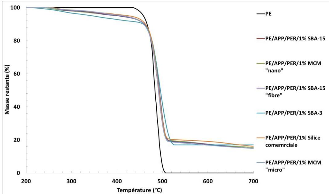
Figure 4.22 : Courbes ATG du PE seul et du système PE/APP/PER/Silice avec une vitesse de chauffage de 10°C/min sous azote.
