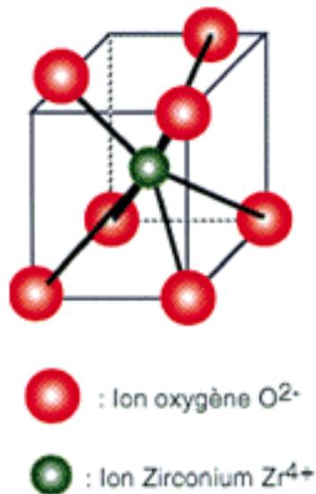
Fig. 2.26 : Structure de l'oxyde de zirconium.
