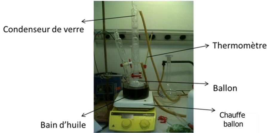
Fig. 2.14 : Schéma annoté du montage utilisé.
