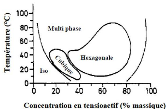
Fig. 2.12 : Diagramme de phase de P123 dans l'eau [5].
