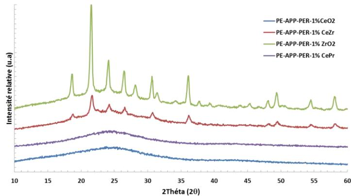
Fig. 4.41 : Diffractogrammes de rayons X des résidus obtenus à 700°C.
