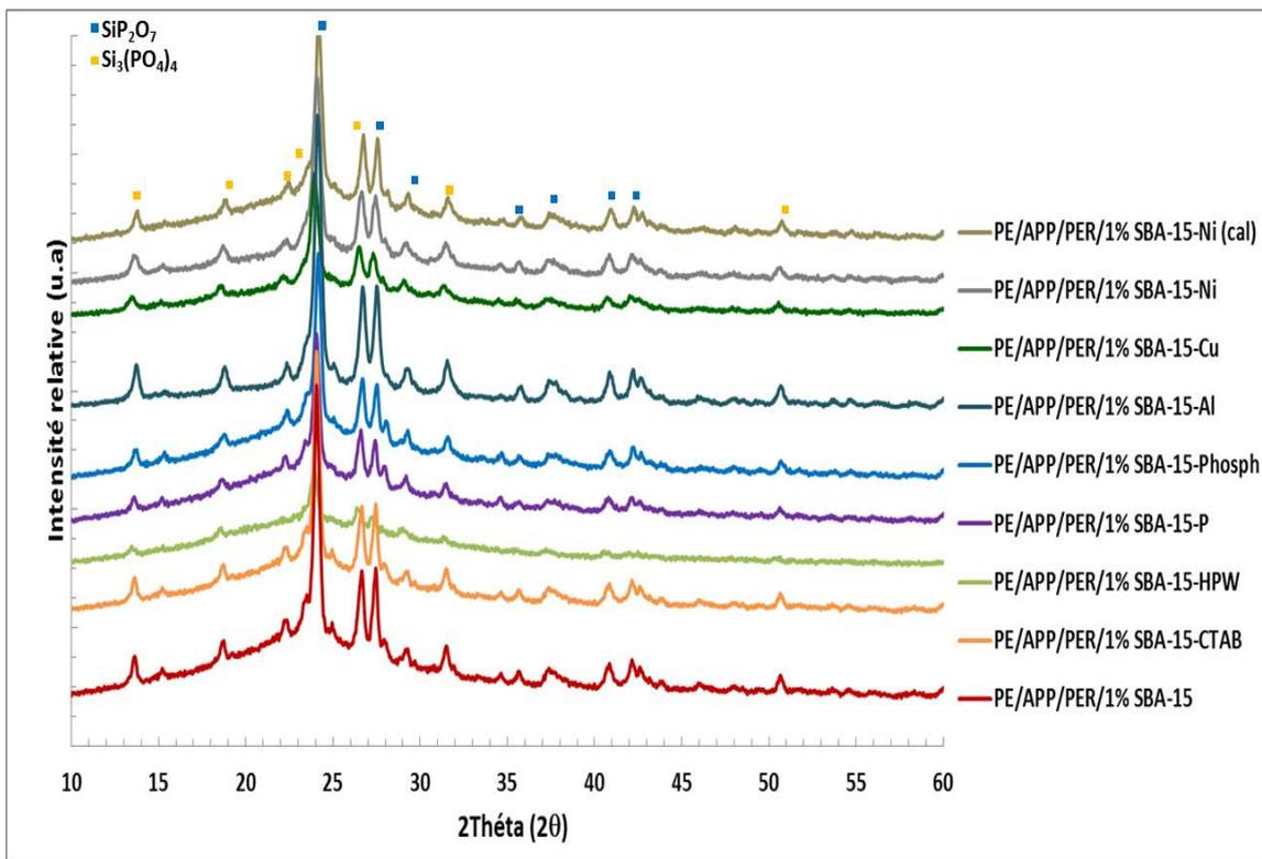
Fig. 4.34 : Diffractogrammes de rayons X après un test au four réalisé sur les composites PE/APP/PER/SBA-15-fonctionnalisés et imprégnés.
