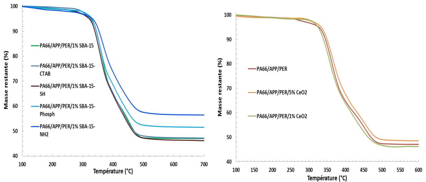
Fig. 4.54 : Courbes ATG des composites PA66/APP/PER/SBA-15-fonctionnalisé et PA66/APP/PER/CeO<sub>2</sub> sous azote (vitesse de chauffage de 10°C/min).
