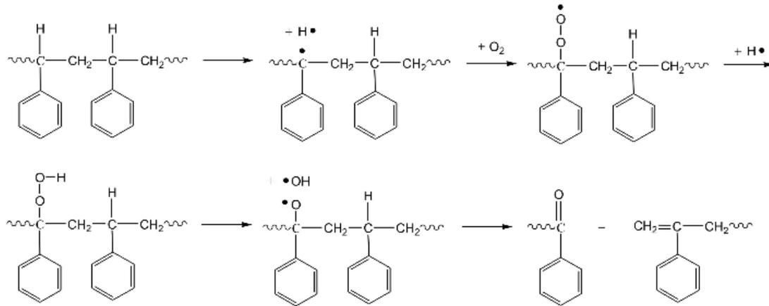
Fig. 1.20 : Mécanisme de dégradation du PS sous air [74].
