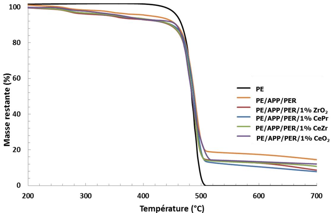
Fig. 4.37 : Courbes ATG des systèmes PE/APP/PER/CeO<sub>2</sub>, PE/APP/PER/ZrO<sub>2</sub>, PE/APP/PER/CePr et PE/APP/PER/CeZr avec une vitesse de chauffage de 10°C/min sous azote.
