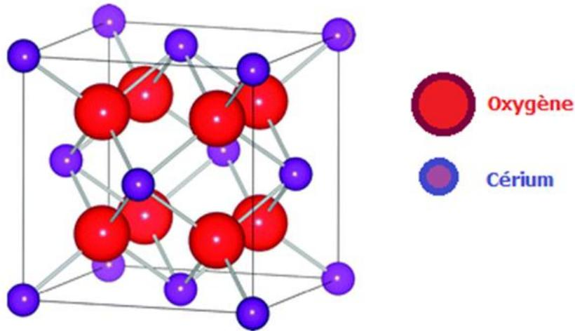
Fig. 2.23 : Structure de l'oxyde de cérium.
