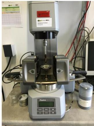
Fig. 2.43 : Viscosimètre de type RHEOPLUS MCR 301.
