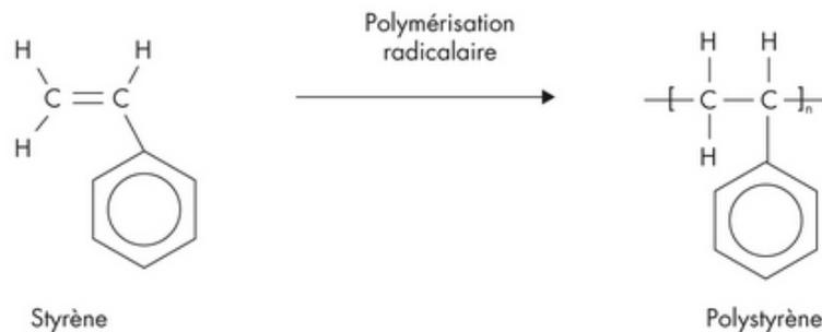
Fig. 1.18 : Polymérisation du polystyrène.
