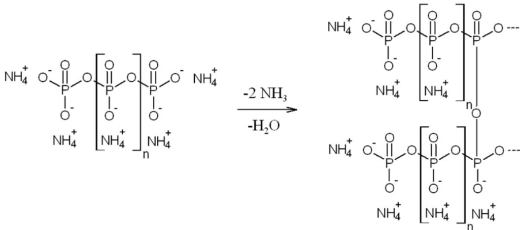
Fig. 3.36 : Mécanisme réactionnel de la réticulation de l'APP [43].
