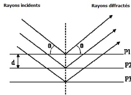
Fig. 2.28 : Principe de loi de Bragg.
