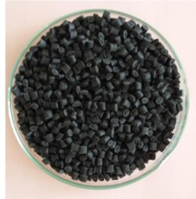
Fig.2.3 : Structure chimique du polyamide 66 (PA66) et les granules PA 66 utilisés.
