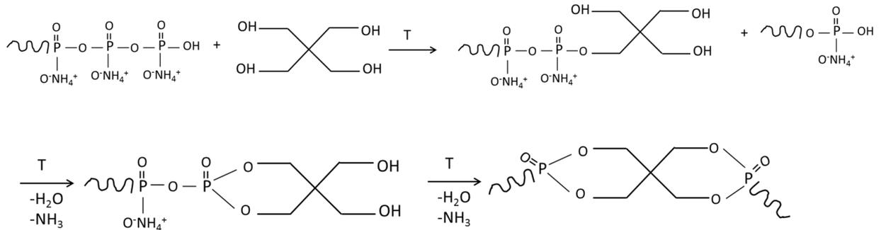
Fig. 3.38 : réaction d'estérification entre l'APP et PER.
