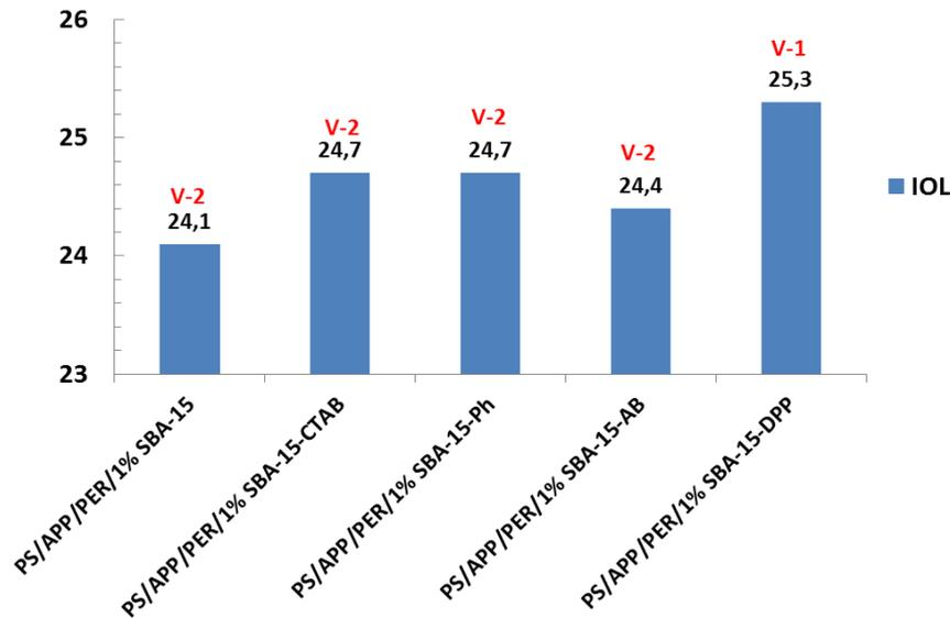
Fig. 4.49 : Indice d'oxygène limite des composites PS/APP/PER/SBA-15-fonctionnalisés.
