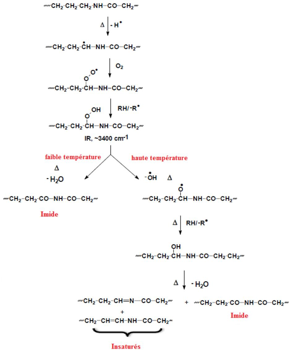
Fig. 1.25 : Mécanisme de thermo-oxydation du polyamide 66.
