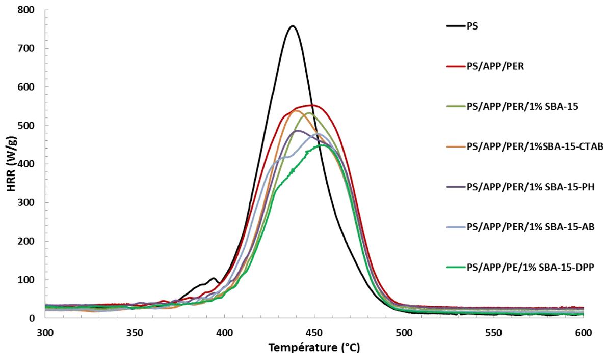
Fig. 4.51: HRR en fonction de la température.
