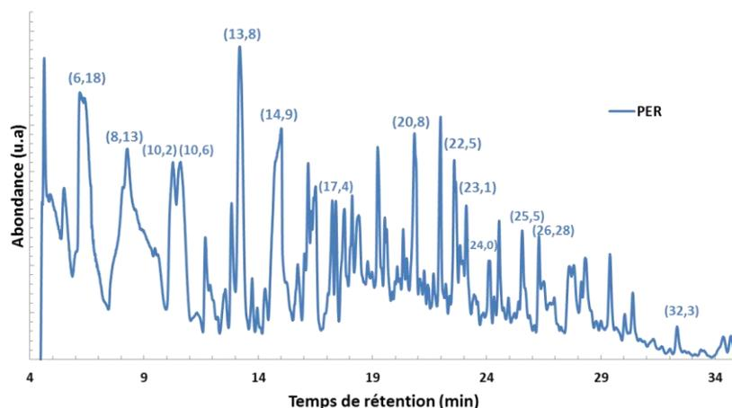
Fig. 3.40 : Chromatogramme des pyrolysats libérés à 600°C par le PER.
