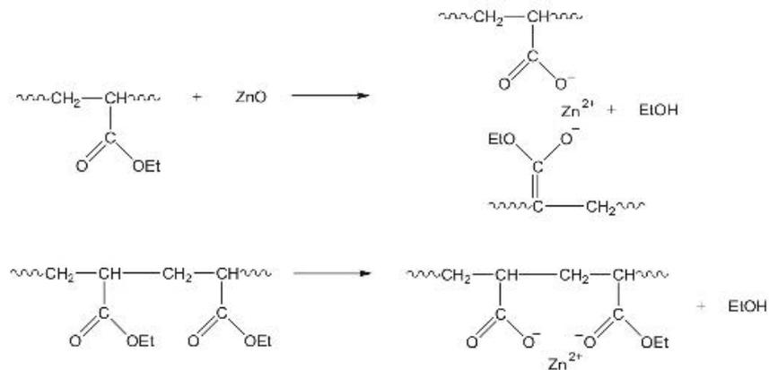
Fig. 1.27 : Interactions entre le polyacrylate et le ZnO.
