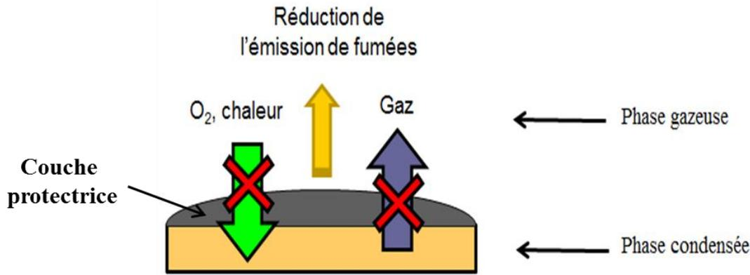
Fig. 1.5 : Schéma de principe de l'effet barrière.
