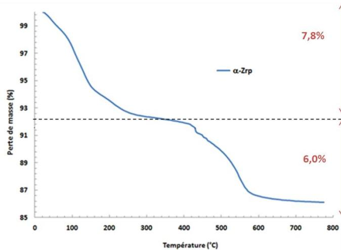
Fig. 3.32 : Analyse thermogravimétrique du  $\alpha$ -ZrP.
