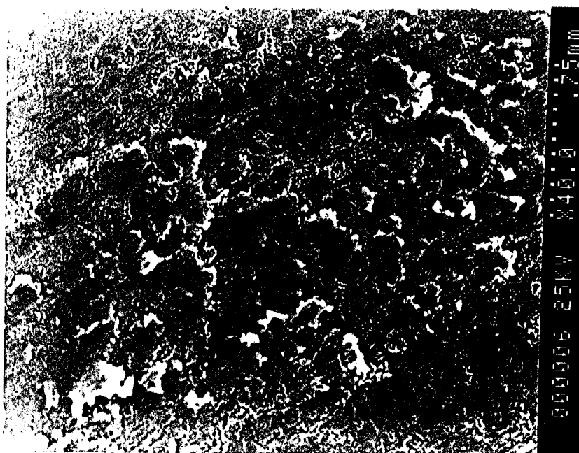
figure IV.15 : Photo d'une piste de glissement d'un graphite mettant en évidence l'orientation des cristallites.
