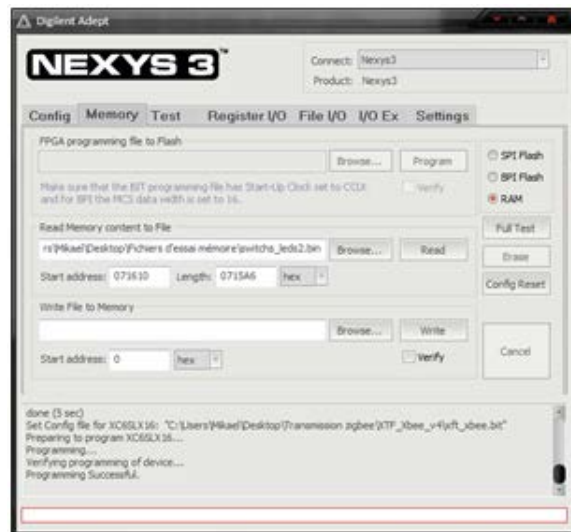
FIGURE 4.15 – Logiciel DIGILENT ADEPT de gestion mémoires SRAM de la plateforme NEXYS3 .
