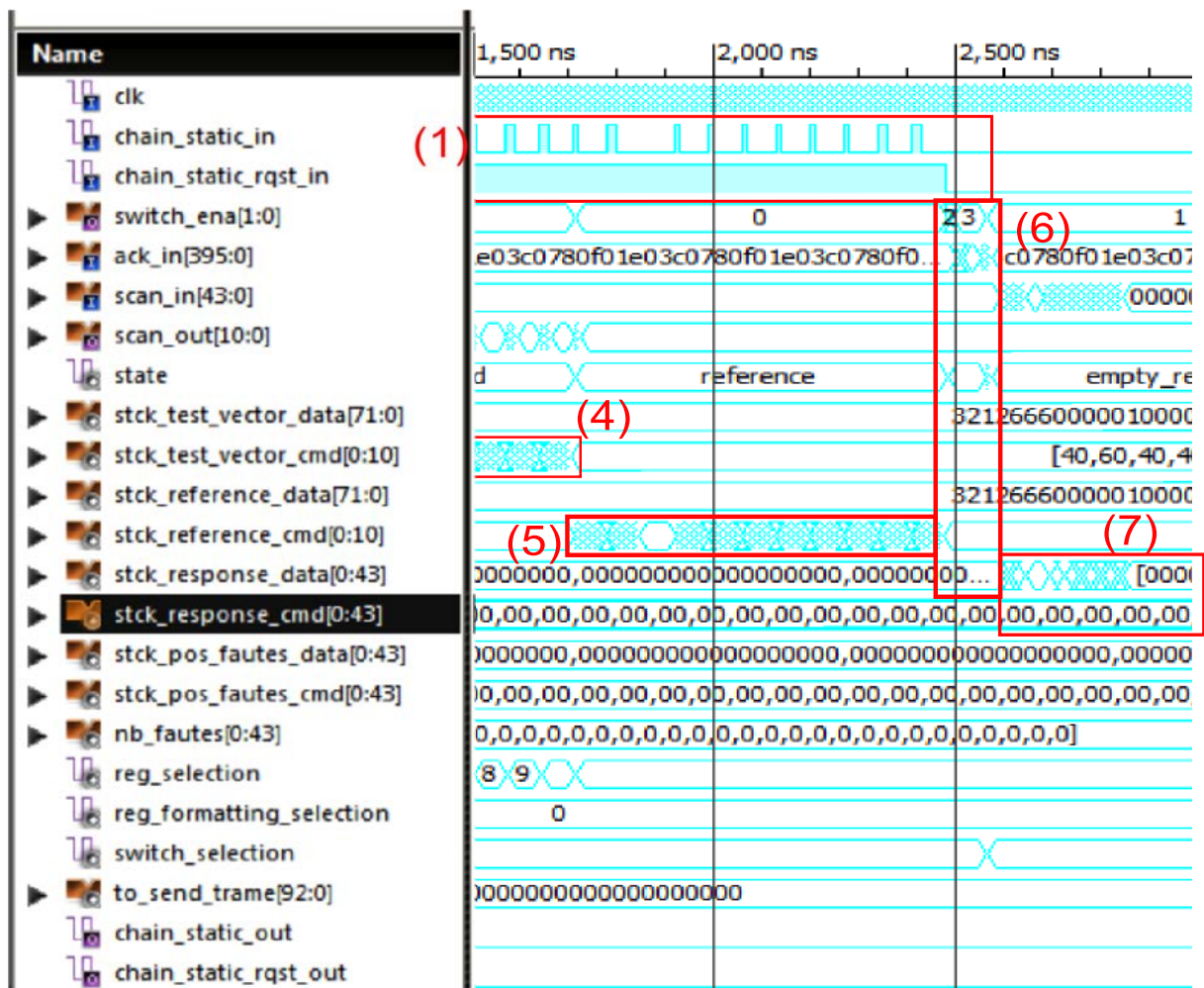
(1) Transmission du Vecteur et de la Référence (3) Stockage de la Référence (données) (5) Stockage de la Référence (cmd) (7) Récupération des Reponses (1 switch) (2) Stockage du Vecteur (données) (4) Stockage du Vecteur (cmd) (6) Test de la ZGS (8) Détection et transmission des erreurs
