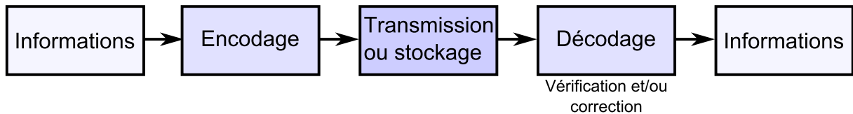
FIGURE 2.6 – Principe de la redondance d’information [Ami11].
