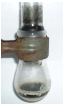
Figure 14 a : acide oléique en cours d'oxydation
