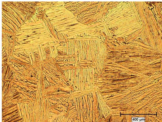
Figure 2: Microstructure héritée du traitement thermique dans le domaine  $\beta$  - échantillon TT1
