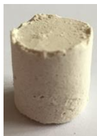
Figure 30 : Aspect des cendres # ZnCl 2 après recuit à 450 °C pendant 1 h suivi d'une trempe à l'air
