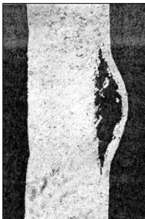
FIG. 1.30: Cible écaillée par impact laser, [Boustie, 1991]
