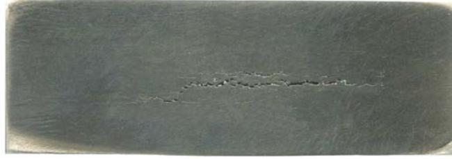
FIG. 2.8: Écaillage d'une cible de TA6V,  $V_{impact} = 300 \text{ m.s}^{-1}$ ,  $L_i = 10 \text{ mm}$
