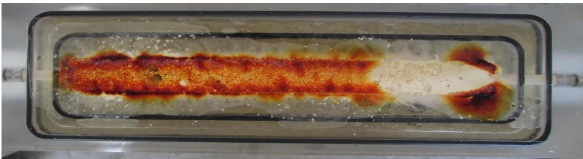
Figure III- 23: Dégradation d'une membrane anionique AMX après un contact de deux jours avec la résine anionique sous forme \text{OH}^- (sans application de courant)
