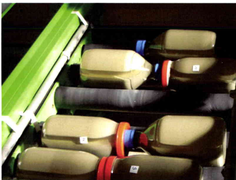
Figure 57. Système d'agitation utilisé pour la contamination en zinc du sédiment naturel au laboratoire.
