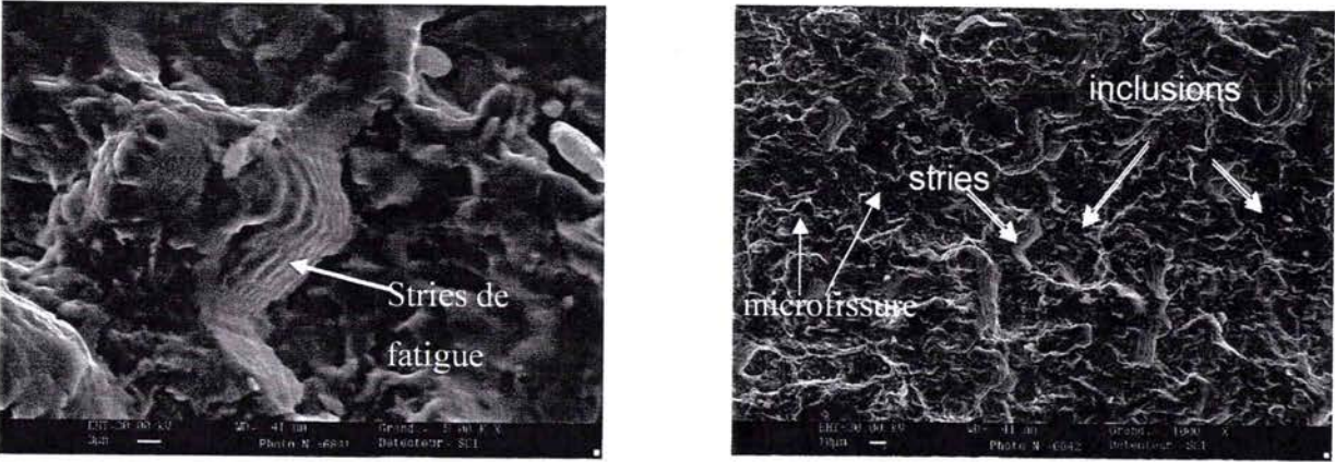
Figure 2.17 : Propagation des fissures et présence d'inclusions.
