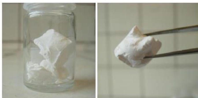
Figure II.3 Photos d'un aérogel élaboré à partir d'un organogel du gélateur (Z-Phe-NH Napht) à 1% en masse dans le toluène.
