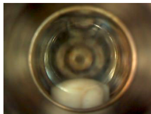
Figure C.5 Apparition de la bulle du mélange
