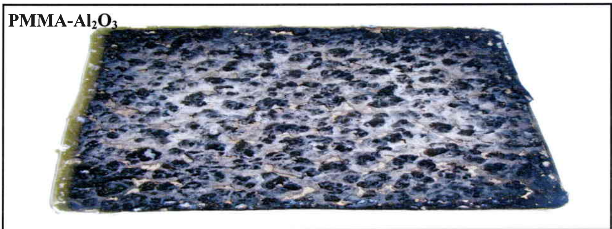
Figure IV. 10 : Photos des résidus des plaques des nanocomposites PMMA-OMMT, PMMA-Oxyde-OMMT et PMMA- Al_2O_3 prises après les tests au cône calorimètre.
