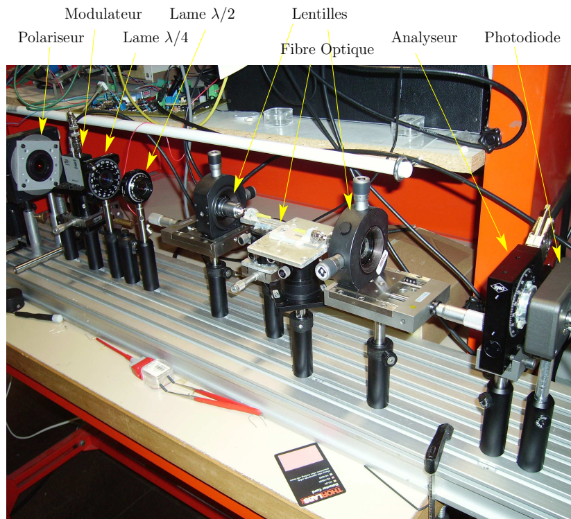
FIG. 2.20: Photo du banc expérimental du capteur en transmission avec fibre optique à maintien de polarisation
