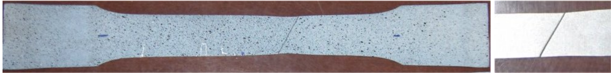
Figure II.20. Eprouvettes de traction après rupture et mouchetis utilisé sur l'acier 304.
