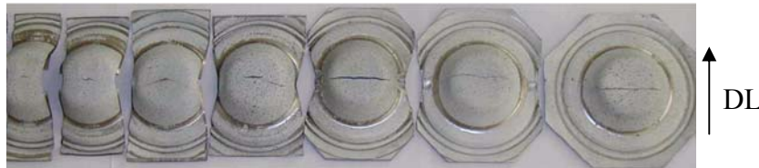
Figure II.25. Représentation des flans emboutis de différentes largeurs jusqu'à rupture
