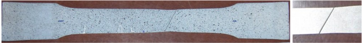
Figure II.20. Eprouvette de traction après rupture et mouchetis utilisé sur l'acier 304.
