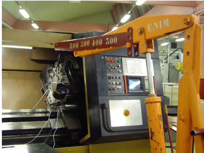
Figure 3.10 : Dispositif de suspension du pot pour l'excitation dans la direction
