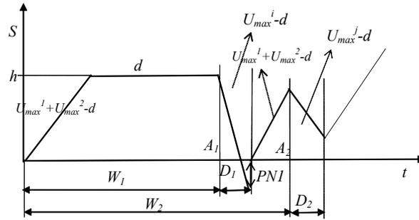
Figure 3.10 : Scénario de type C, pas d'arrêt simultané,  $h$  non atteint une 2<sup>ème</sup> fois, existence de pénuries par arrêt de la 1<sup>ère</sup> machine qui subit les actions de maintenance
