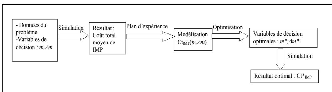
Figure 2.12 : Méthodologie utilisée pour l'optimisation de IMP.
