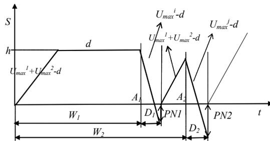
Figure 3.8 : Scénario de type C, Pas d'arrêt simultané, on n'atteint pas  $h$  une 2<sup>ème</sup> fois et des pénuries sont causées par l'arrêt des deux machines
