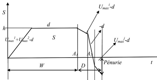
Figure 3.15 : Scénario de type D, début des pénuries pendant la phase d'arrêt pour maintenance simultané des deux machines
