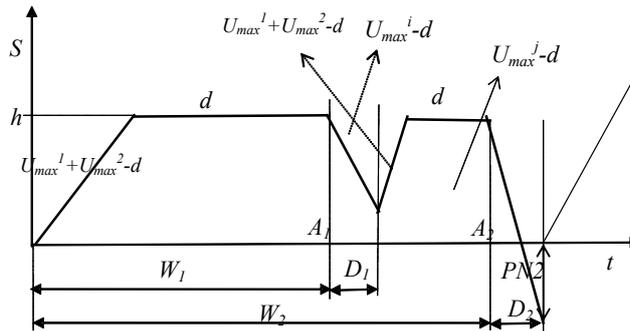
Figure 3.12 : Scénario de type C, pas d'arrêt simultanée des deux machines, niveau  $h$  atteint une deuxième fois, existence de pénuries par arrêt de la deuxième machine qui subit les actions de maintenance
