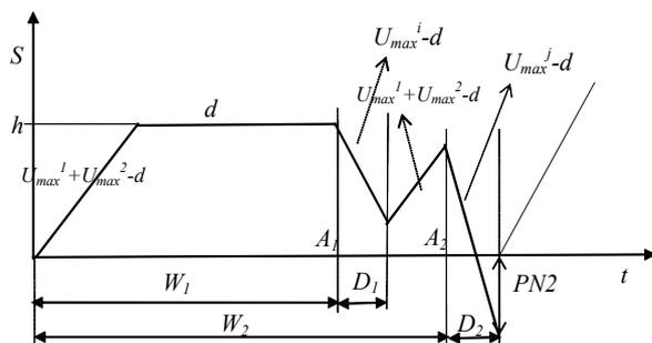
Figure 3.9 : Scénario de type C, Pas d'arrêt simultané,  $h$  non atteint une deuxième fois et existence de pénuries par arrêt de la 2<sup>ème</sup> machine qui subit les actions de maintenance
