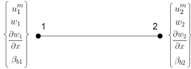
FIG. 5.7 – Élément 1D zigzag en prenant le déplacement de la face au milieu
