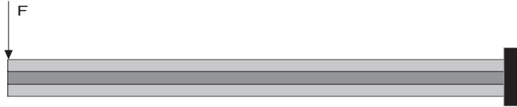
FIG. 1.6 – Poutre sandwich encasté-libre
