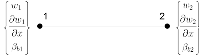
FIG. 1.5 – Élément 1D zig-zag basé sur ID-ZZT
