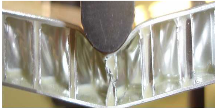
FIG. 5.1 – Flambage locale de sandwich nids d’abeille en flexion trois points (Figure obtenue par les essais de M. A. Abbadi)
