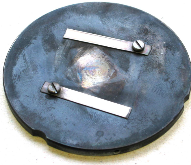
Fig. 2.10: Le porte-substrat avec les languettes en acier inoxydable.
